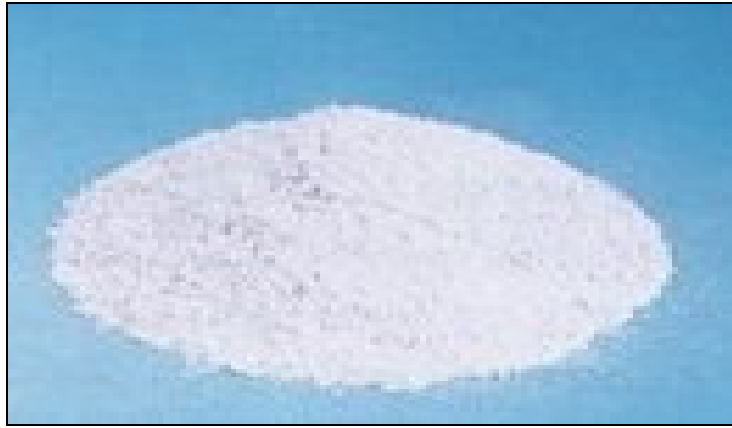
Resim 2.2 Genleştirilmiş mikronize perlit (Doğan 2001).
