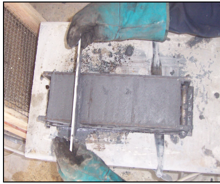
Resim 3.6 Numunenin kalıba yerleştirilmesi
