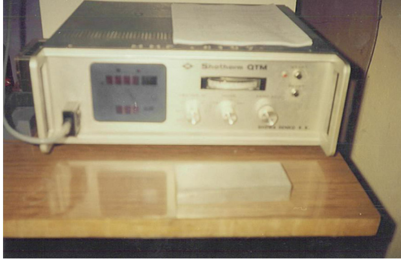
Resim 4.1 Örneklerin ısı iletkenlik katsayısı değerlerinin ölçüldüğü Shotherm QTM-D2 cihazı.
