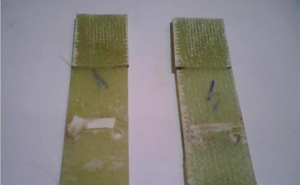
Resim 6.2 Lifli ve düğümlü kompozit kopmuş hali
