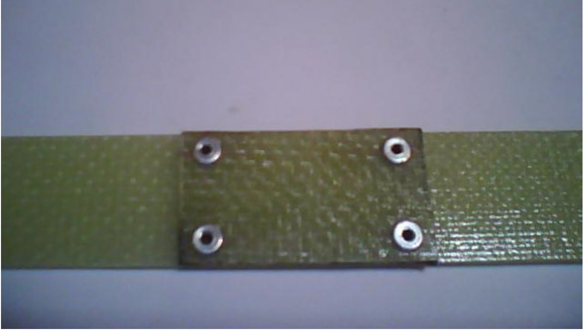
Resim 6.5 Pimli bağlantılı kompozit tamirati
