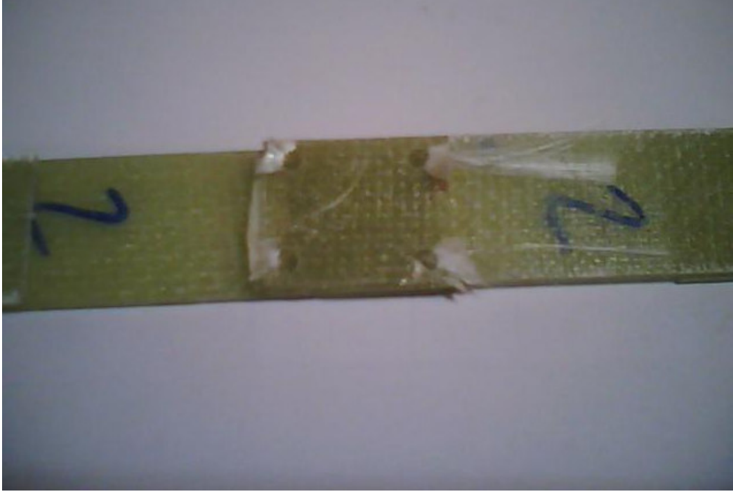
Resim 6.3 Sadece lifli kompozit tamirati
