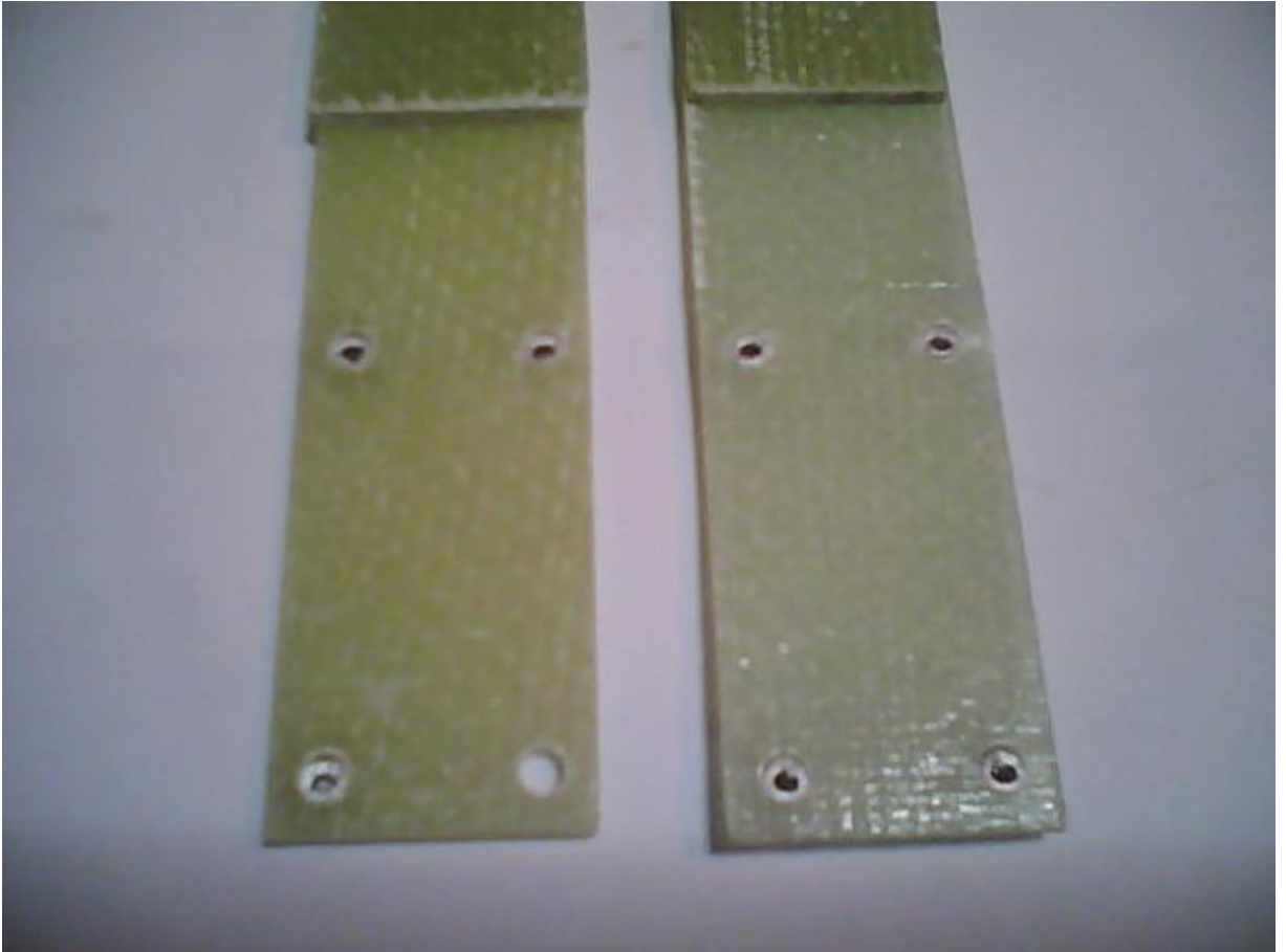
Resim 6.6 Pimli bağlantılı kompozitin kopmuş hali
