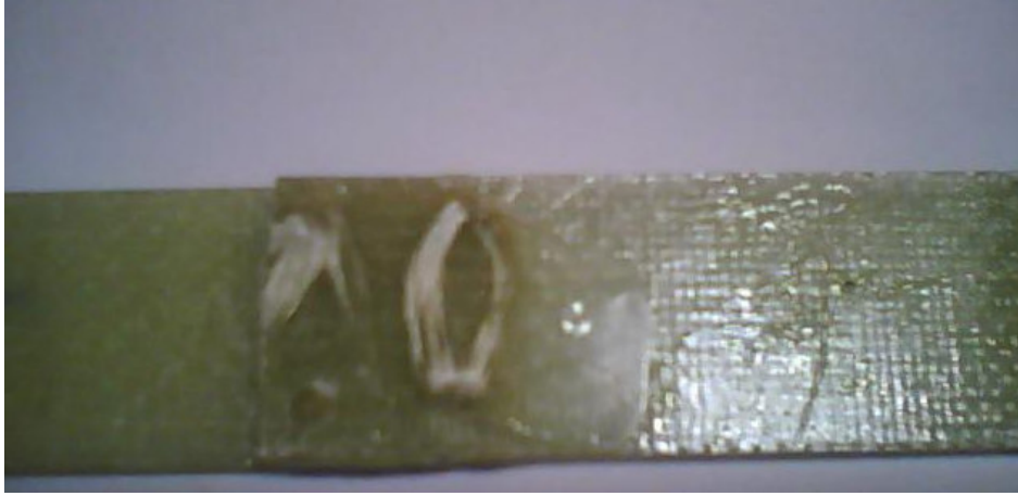
Resim 6.1 Lifli ve düğümlü kompozit tamiratı
