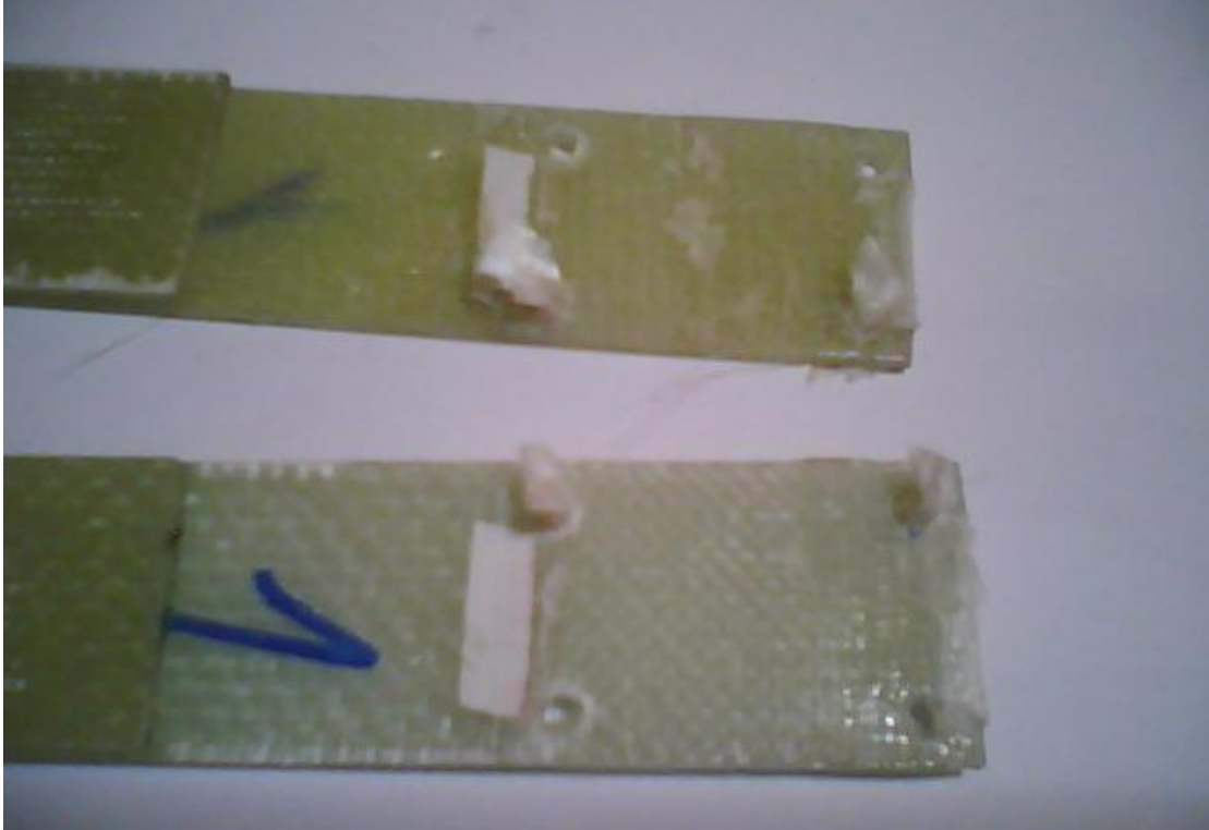
Resim 6.4 Sadece lifli kompozitin kopmuş hali
