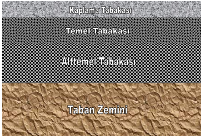
Şekil 2.2 Tipik Bir Esnek Üstyapı En Kesiti.
