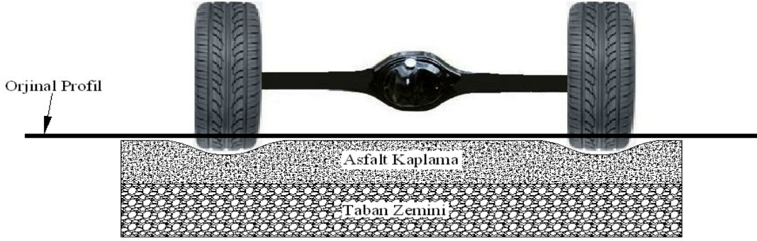
Şekil 2.5 Konsolidasyon ve Yüzeysel Tekerlek İzi.
