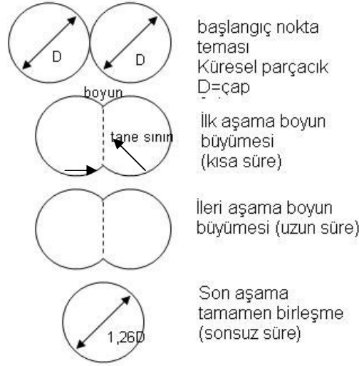
Şekil 2.4 Sinterleme nokta teması ile başlayan ve parçacıklar arası bağ gelişimini gösteren iki küre sinterleme modeli
