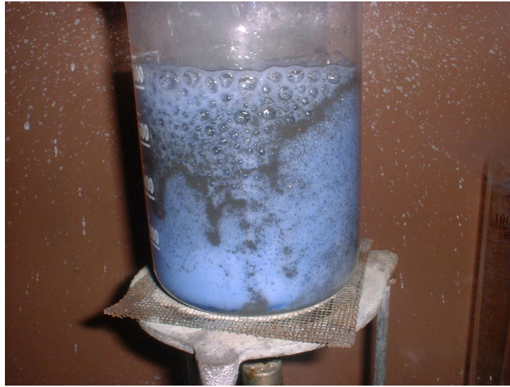
Resim 3.2 Akımsız nikel kaplamada reaksiyon görüntüsü
