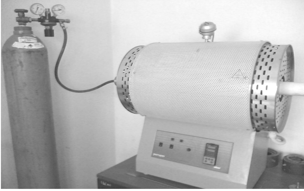
Şekil 3.9. Sinterleme işlemi için kullanılan atmosfer korumalı tüp fırın.
