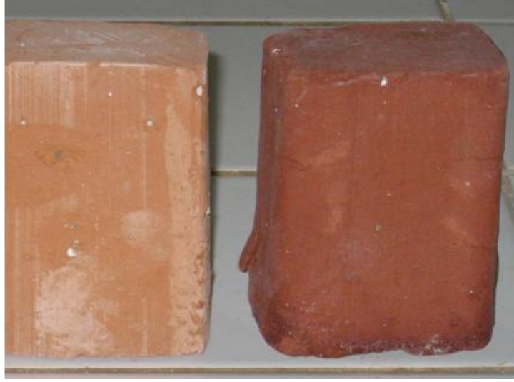
Şekil 4.9 1000 °C’de pişen örneklerin pişme rengi özellikleri (katkısız örnek solda ve % 2 BA katkılı örnek sağda).
