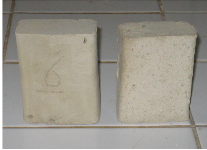
Şekil 3.3 Laboratuvar tipi ekstrüzyon makinesinde üretilen tuğla örnekler.
