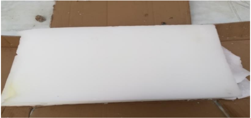
Şekil: 2.26. Enerji Depolama Malzemesi Olarak Kullanılan Parafin
