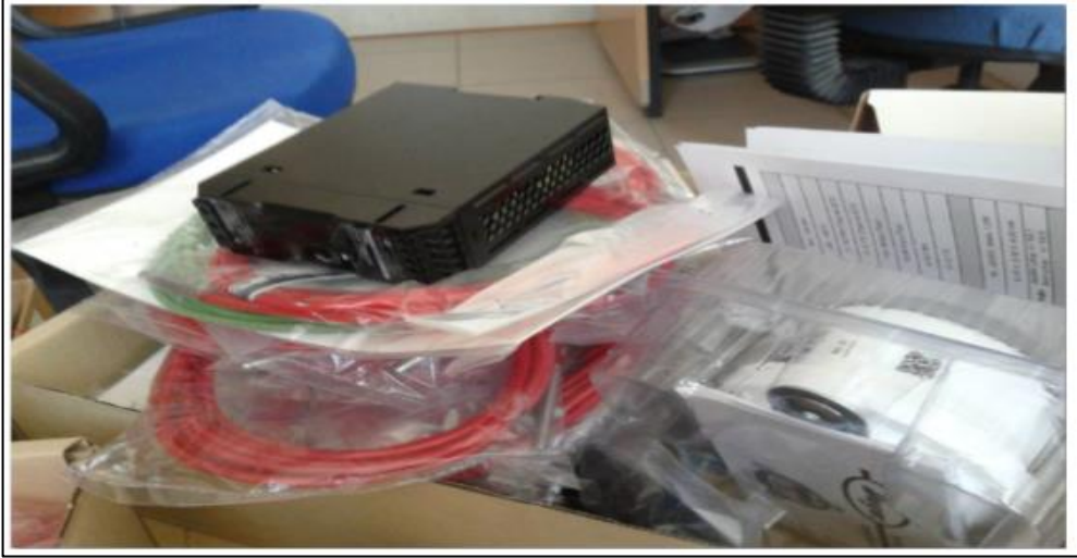
Şekil: 3.14. Thermocouple Ve Datalogger Güç Kaynağı Resmi
