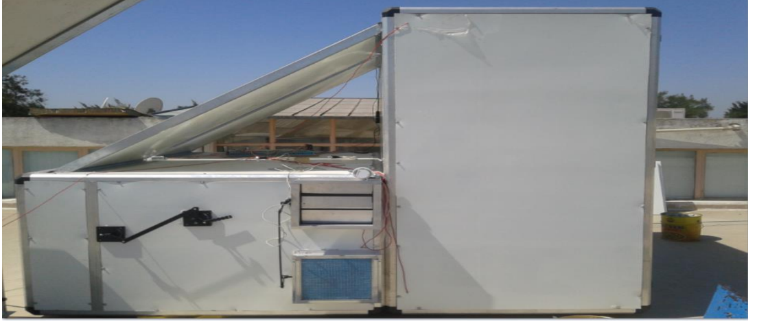
Şekil: 3.5. Güneş Enerjisi Destekli Enerji Depolama Sistemli Ürün Kurutma Sistemi Resmi (Yandan Görünüşü)
