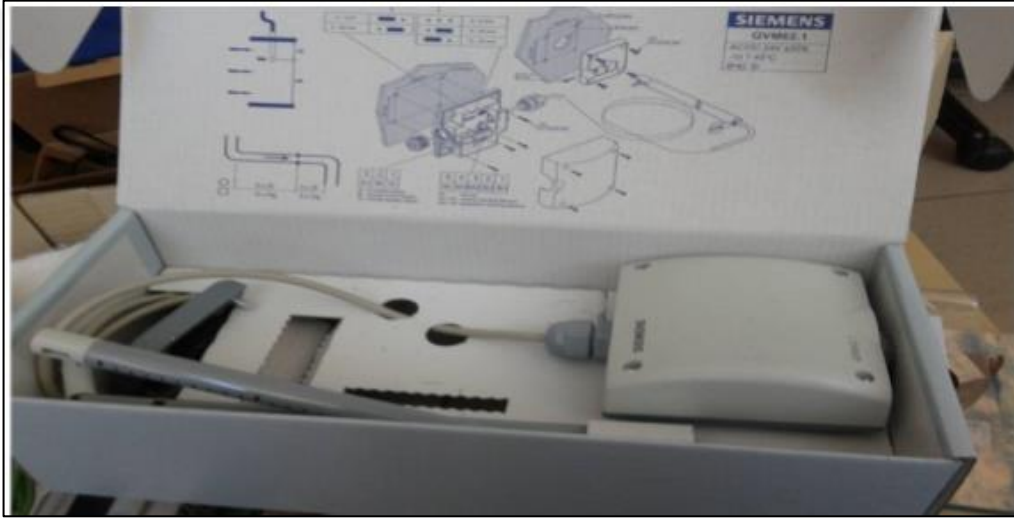
Şekil: 3.15. Anemometre ( Hava Hızı Ölçüm Cihazı) Resmi
