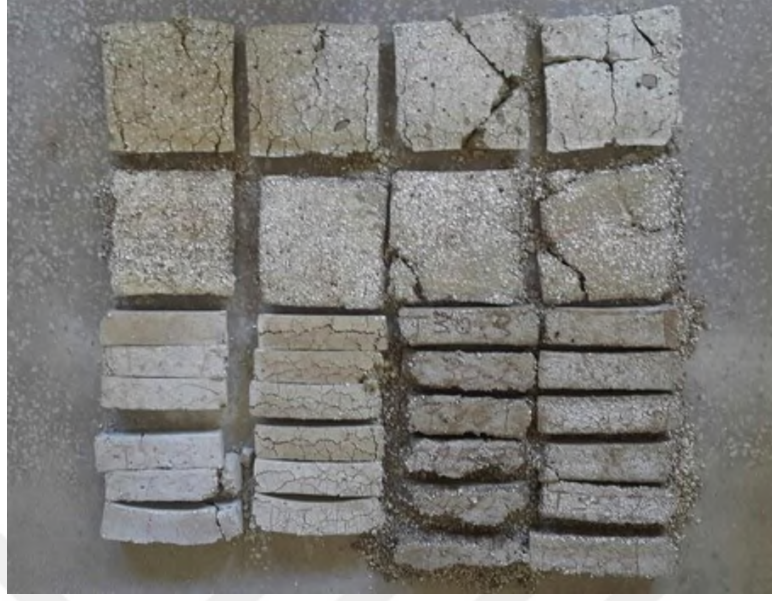
Şekil 4.6. Numunelerin 900 °C Sıcaklığa Maruz Bırakıldıktan Sonraki Durumu
