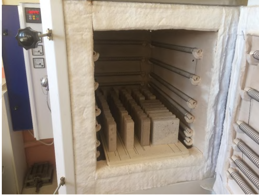
Şekil 4.1. Numunelerin 300 °C Sıcaklığa Maruz Bırakıldıktan Sonraki Durumu
