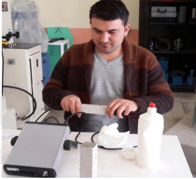
Őekil 3.9. Ultra Ses Geçiř Hızının Belirlenmesi
