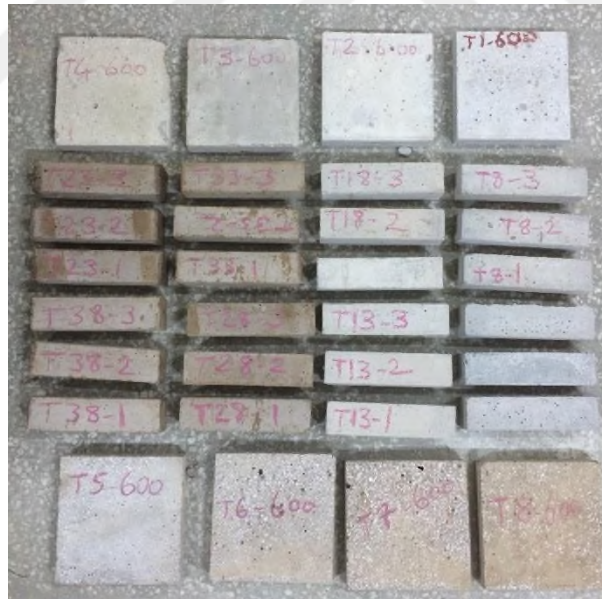
Şekil 4.5. Numunelerin 600 °C Sıcaklığa Maruz Bırakıldıktan Sonraki Durumu
