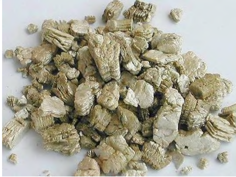
Şekil 2.3. Isıya Tabi Tutulmuş Vermikülit [32]
