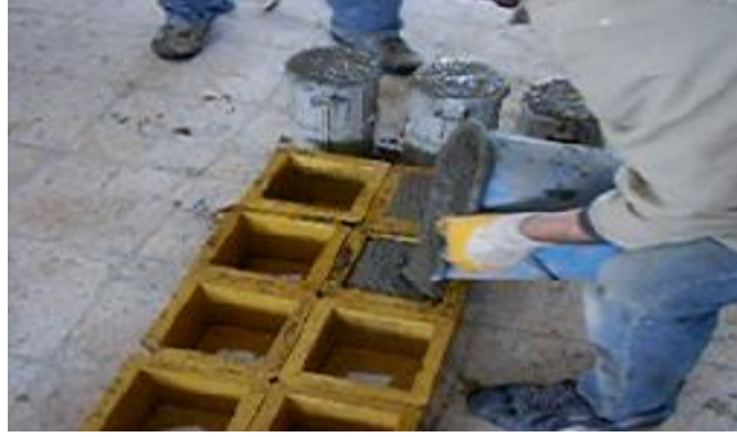
Resim 3.8 Kalıpların taze beton ile doldurulması
