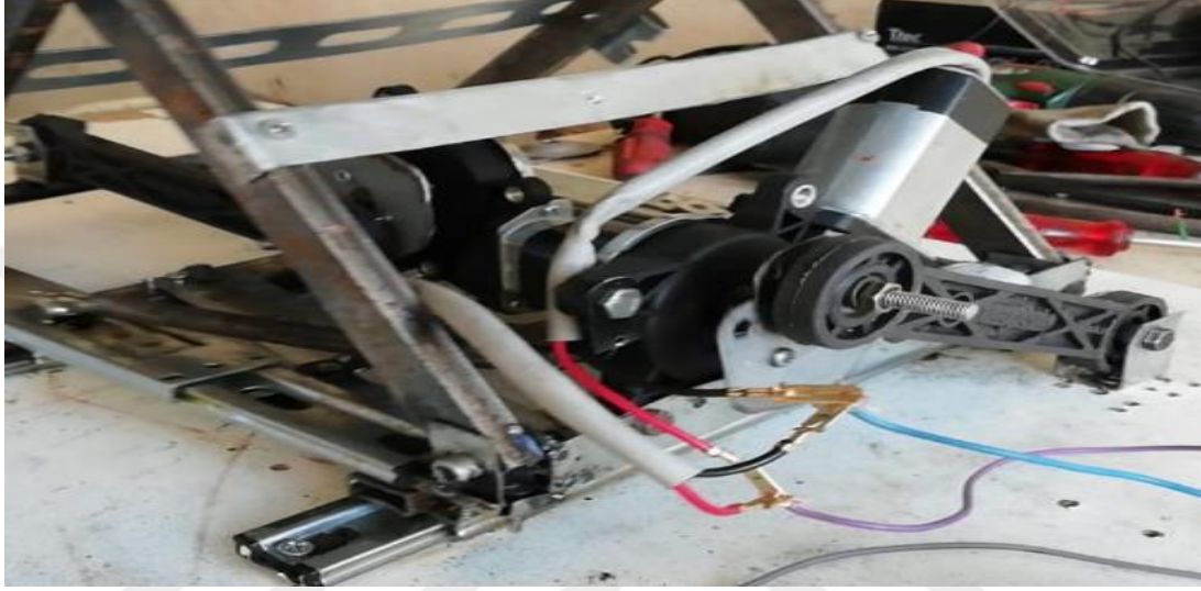
Şekil 5.2: Redüktörlü DC Motorun Krank-Biyel Mekanizmasına Eklenmesi
