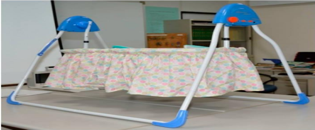
Şekil 1.4 : Rezonant Elektrik Beşiği
