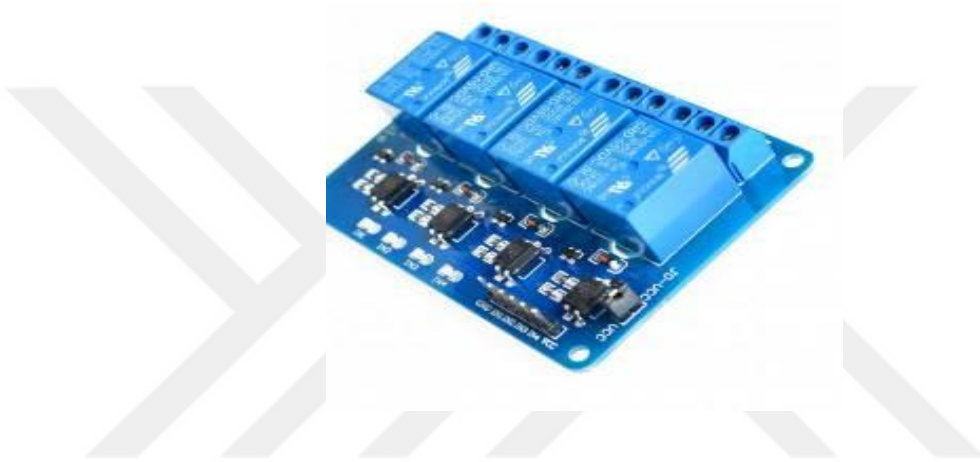
Şekil 3.7 : 5V 4 Kanallı Röle Kartı
