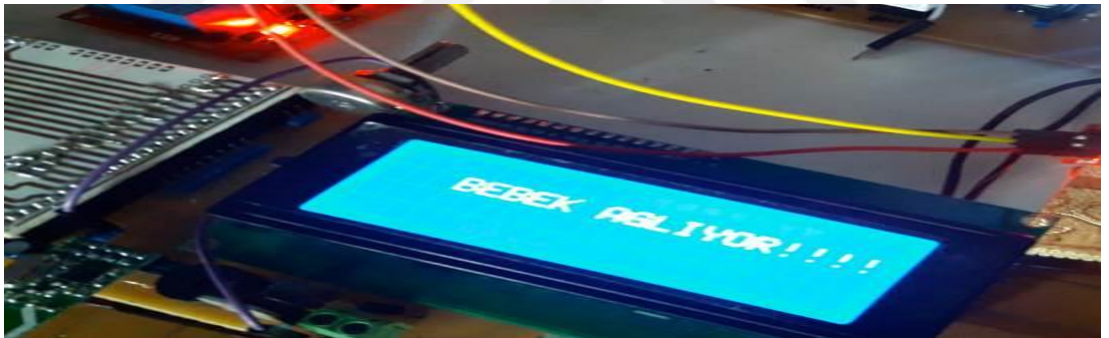
Şekil 5.10: Alıcı Devresinde Bebek Ağlama Uyarısı
