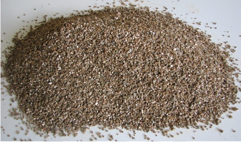
Şekil 3.2. Çalışmada Kullanılan Genleştirilmiş Vermikülit
