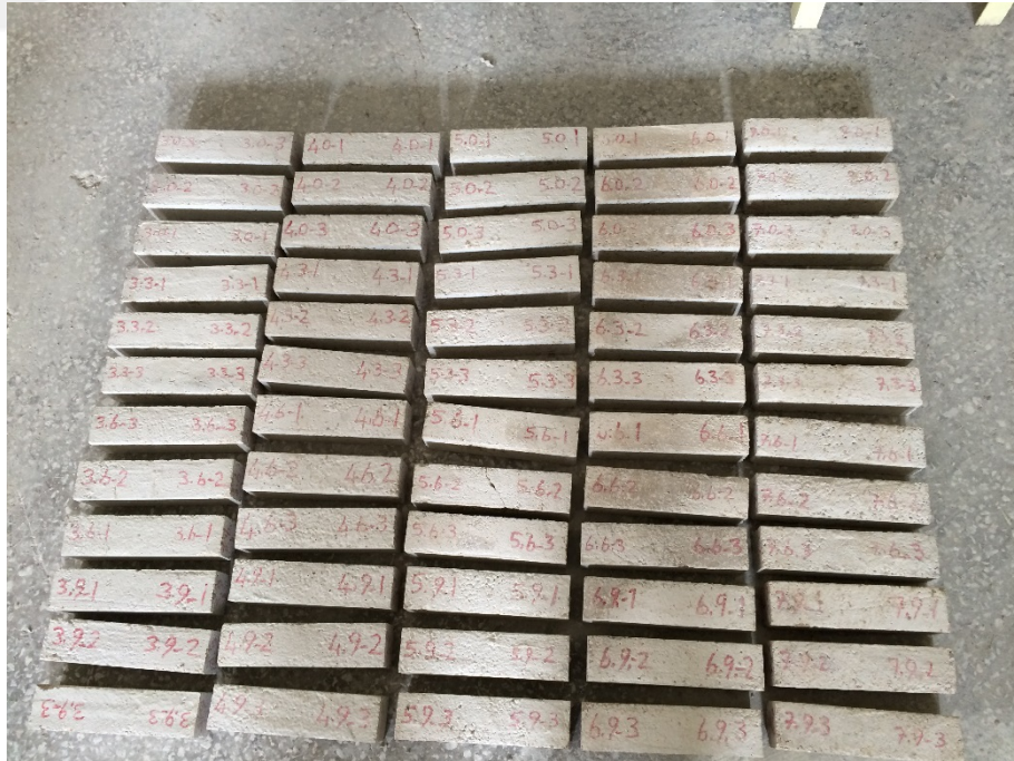
Şekil 3.6. Numunelerin Sıcaklık Uygulanmadan Sonraki Durumu
