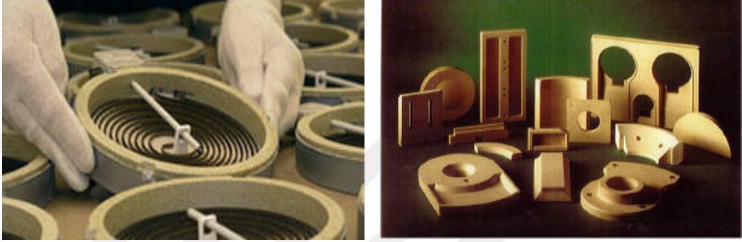
Şekil 2.11. Vermikülitin Üretimde İzolasyon Malzemesi Uygulaması [35]
