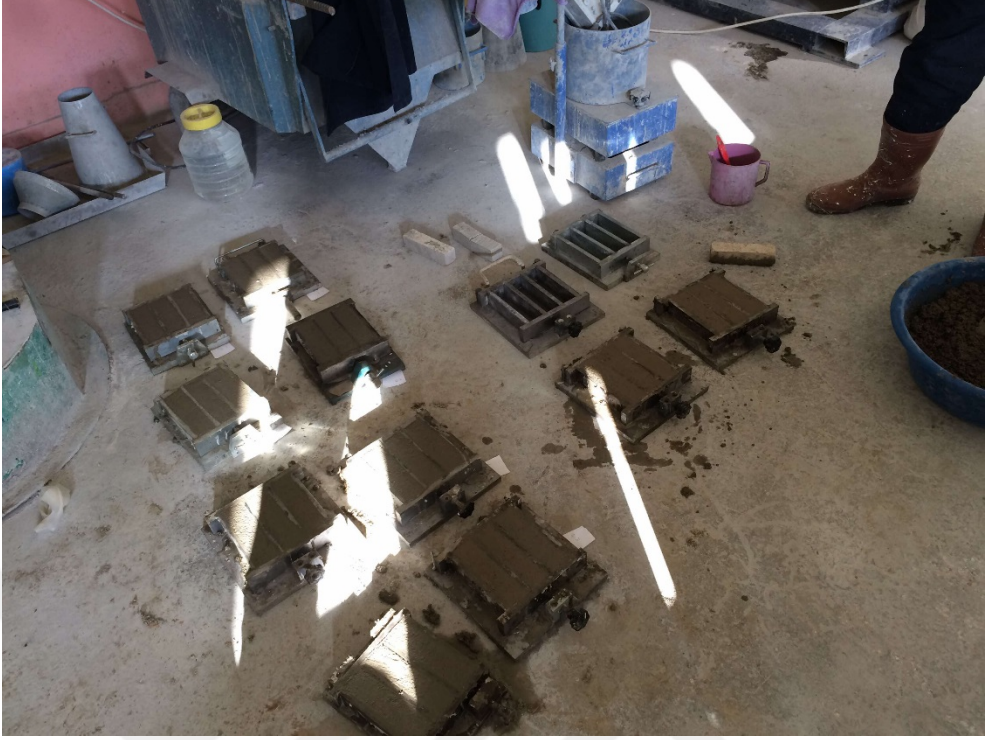
Şekil 3.4. Harcın Kalıba Yerleştirilmiş Hali
