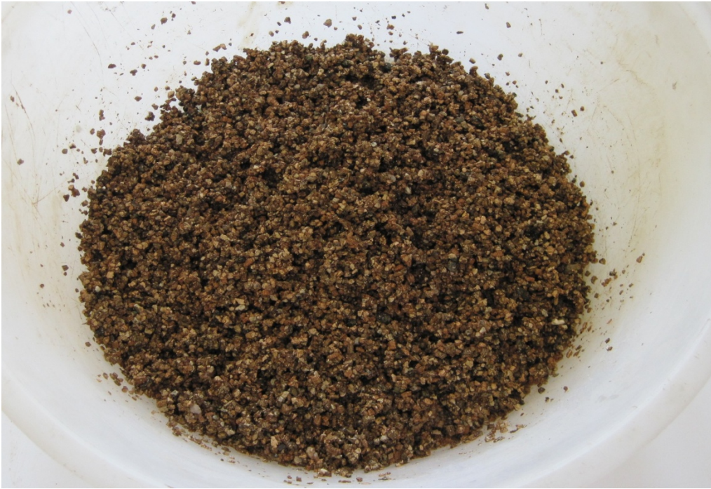
Şekil 3.3. Genleştirilmiş Vermikülitte Su ilave Edilmesi
