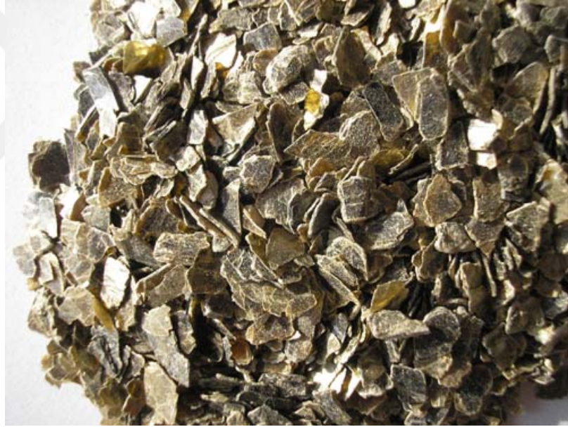
Şekil 2.2. Elekten Geçirilmiş Ham Vermikülit
