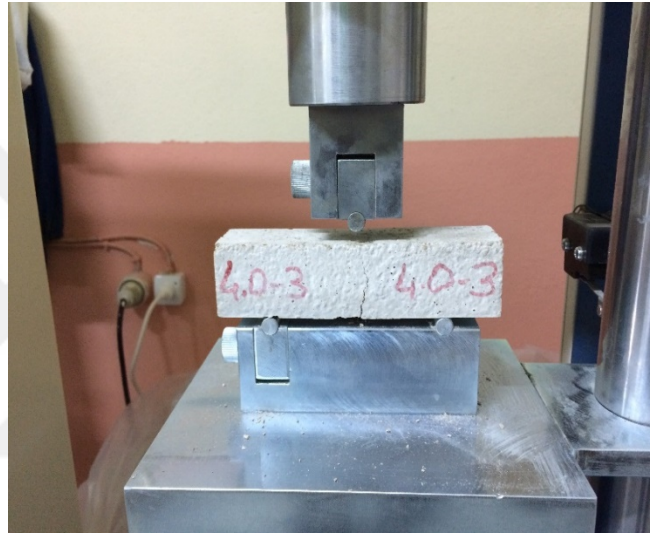
Şekil 3.8. Eğilme Dayanımı Tayini Deneyi.
