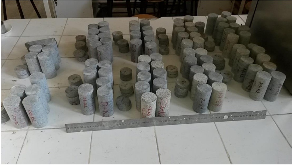
Şekil 3.3. Bloklarının mühendislik parametrelerini belirlemek üzere hazırlanmış silindirik örneklerin bir kısmı.
