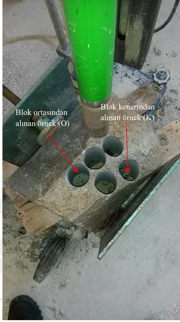
Şekil 3.2. Bloklardan silindirik örneklerin hazırlanması.
