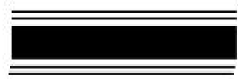
Şekil 5.2 Hava Basıncı Fazla Olan Lastik İzi
