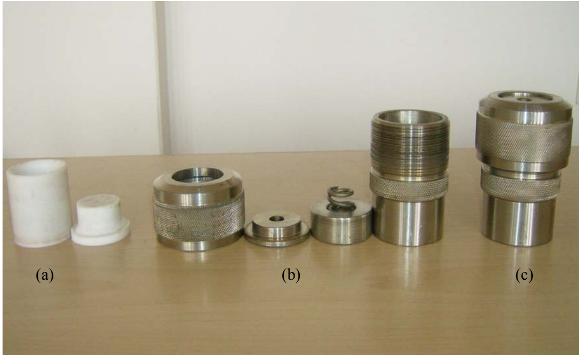
Resim 3.1 (a) Teflon reaksiyon kabı ve kapaęı (b) Basınca dayanıklı asit sindirme kabı ve parçaları (c) Deneye hazır, kapalı reaksiyon kabı
