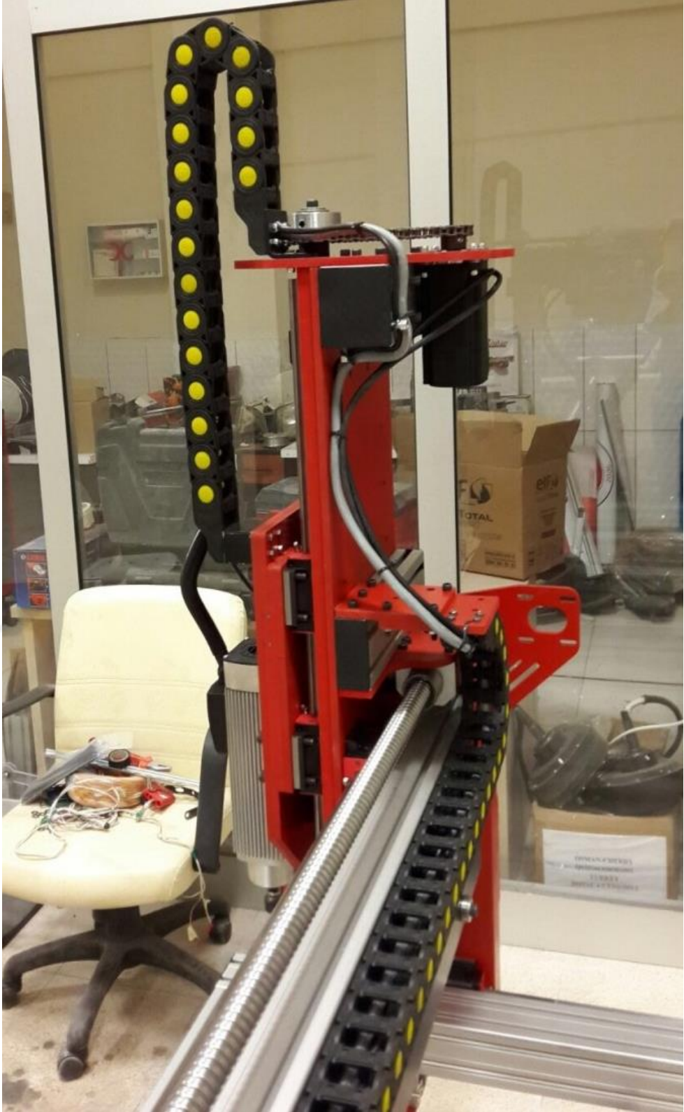
Şekil 4.38 Z Eksenli Motor Bağlantı Plakası Montajı
