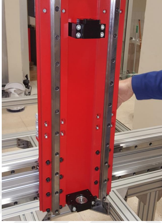
Şekil 4.13 Z Eksen Plakalarının Katmanlar Halinde Montajı
