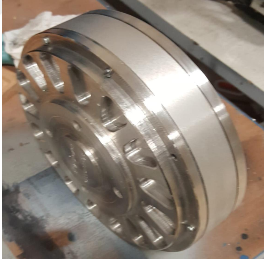
Şekil 6.8 Hub Motor İmalatı
