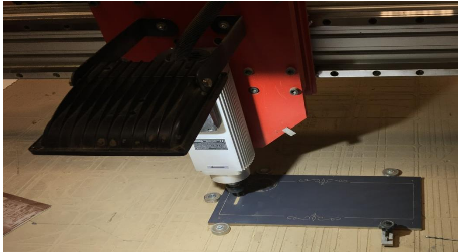
Şekil 6.4 Kapı İsimliklerinin CNC Tezgâhta İşlenmesi
