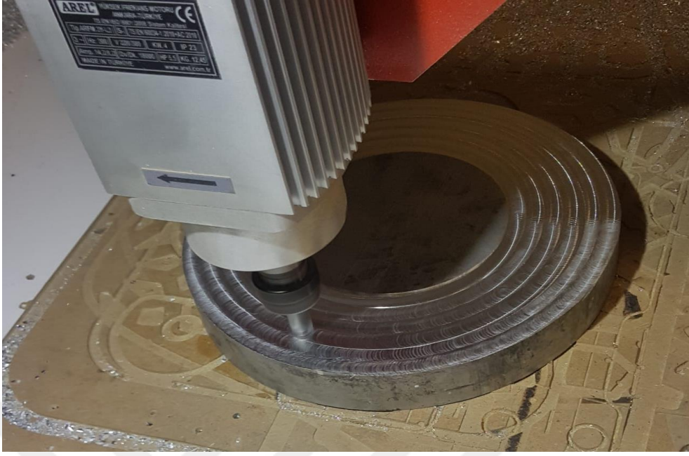
Şekil 6.7 Hub Motor Parçalarının CNC Tezgâhta İşlenmesi
