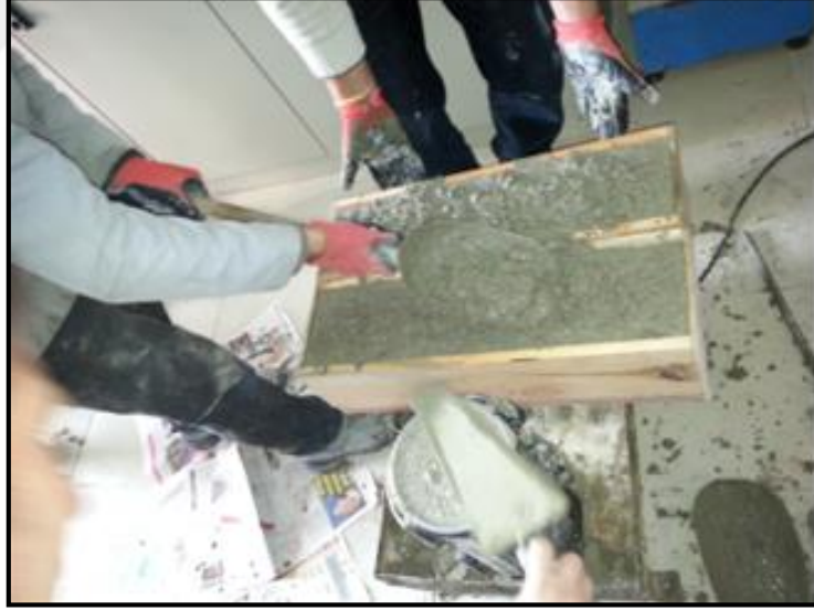
Şekil 3.3. Karışım Harcının Numune Kaplarına Konulması
