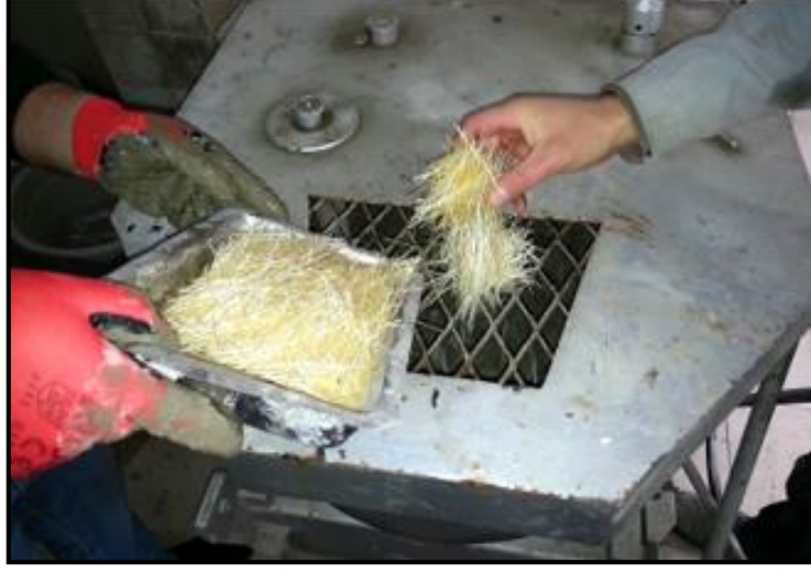
Şekil 3.3. Liflerin Harç İçerisine Katılması
