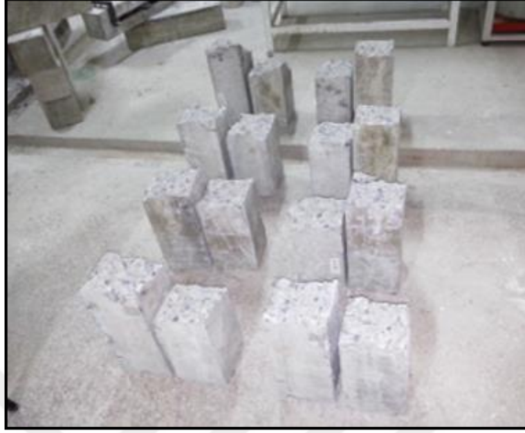
Şekil 3.23. Kiriş Numunelerin Eğilme Deneyi Sonrası Görünümü
