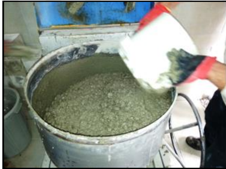
Şekil 3.2. Agrega Çimento ve Su Karışım Harcı Hazırlanması
