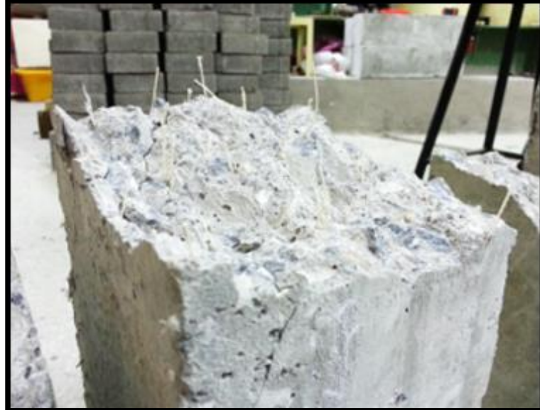
Şekil 3.12. Kiriş Numunesinin Eğilme Deneyi Sonrası Kesit Görünümü
