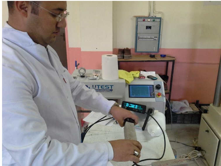
Şekil 3.6. Ultra Ses Geçiş Hızının Belirlenmesi
