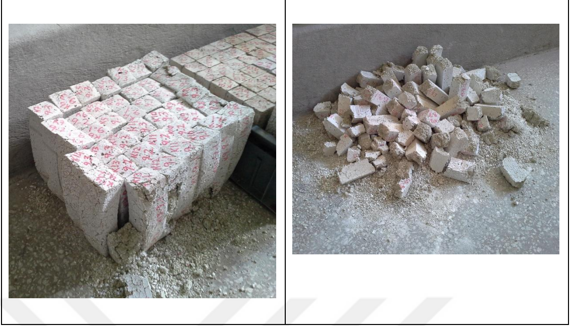
Şekil 4.2. Numunelerin 900 °C Sıcaklığa Maruz Bırakıldıktan Sonraki Durumu
