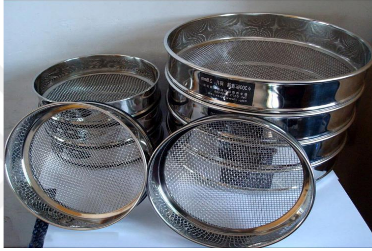
Şekil 5.2. Elek analizinde kullanılan elekler
