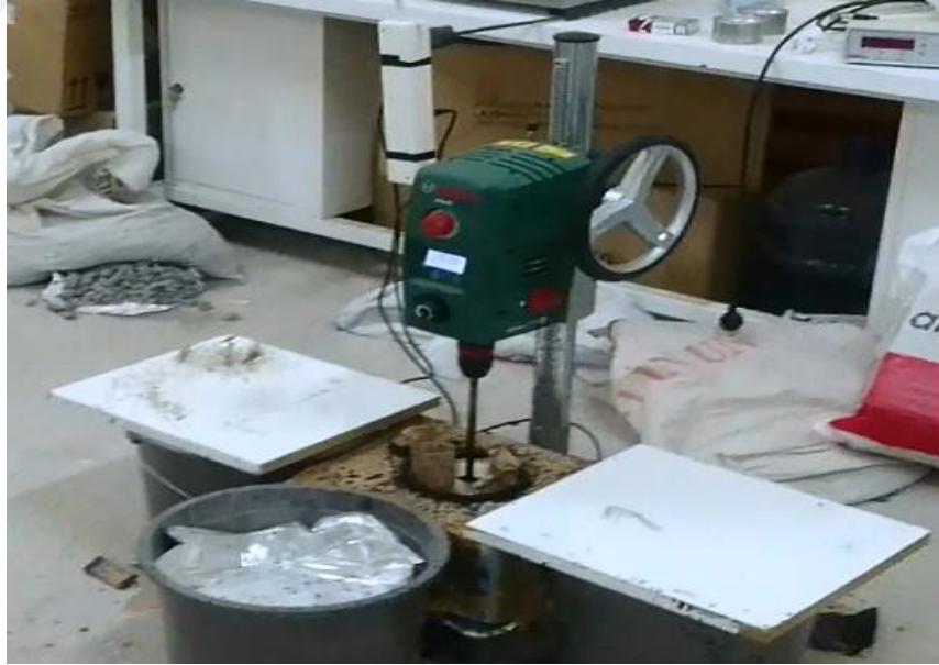
Şekil 5.1. Karışımın mikser yardımı ile hazırlanması
