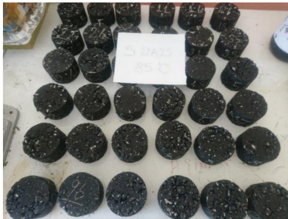
Şekil 5.6. 5 gün boyunca 85 °C de yaşlandırmaya tabii tutulan numuneler
