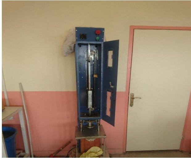
Şekil 5.5. Marshall Tokmağı ile numunelerin sıkıştırılması
