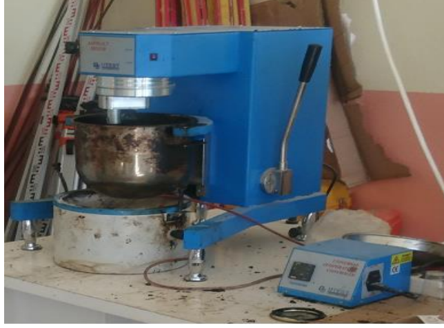
Şekil 5.4. Agrega ve modifiye bitümün karışımının yapılması
