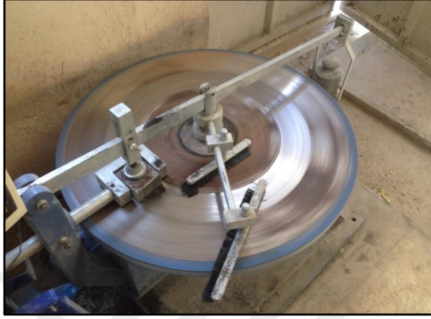
Şekil 3.24. Aşınma Deneyi Böhme Cihazı Görünümü
