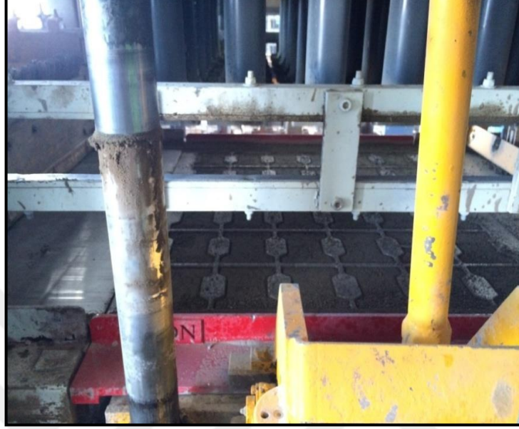
Şekil 3.17. Numune Üretilirken Uygulanan Baskı Makinesi
