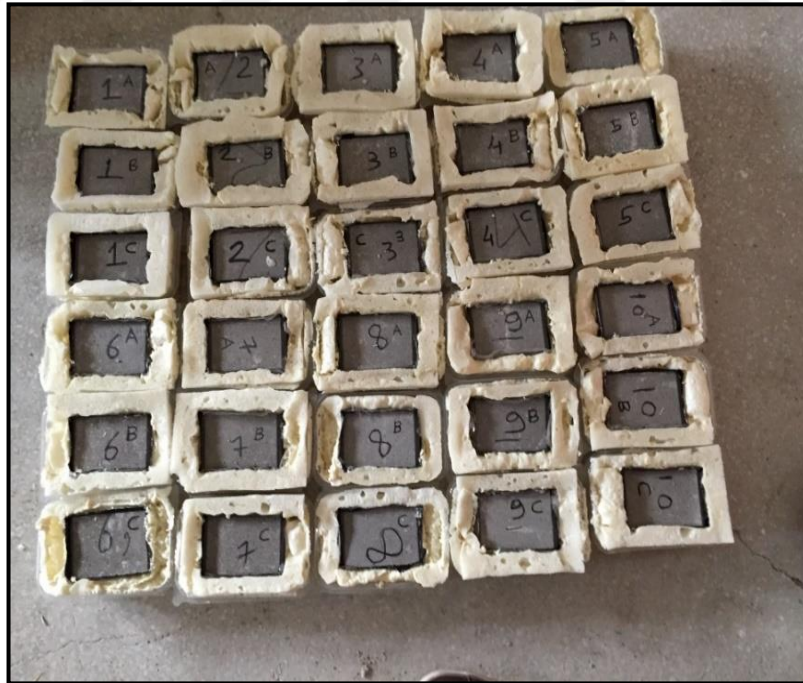
Şekil 3.31. Donma-Çözülme Deneyi İçin Hazırlanan Numune Görünümü
