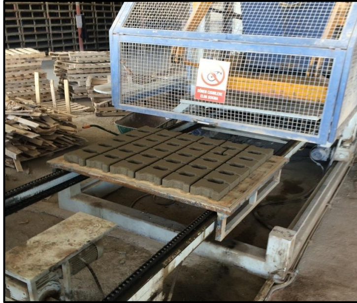
Şekil 3.18. Numune Üretilirken Uygulanan Baskı Makinesi
