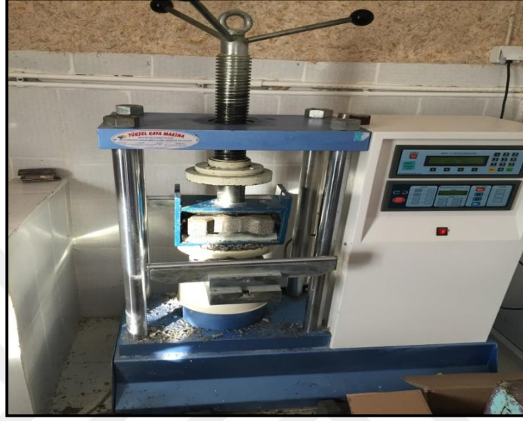
Şekil 3.27. Yarma Deneyi Düzeneği Sorgun Taş Ltd. Şti
