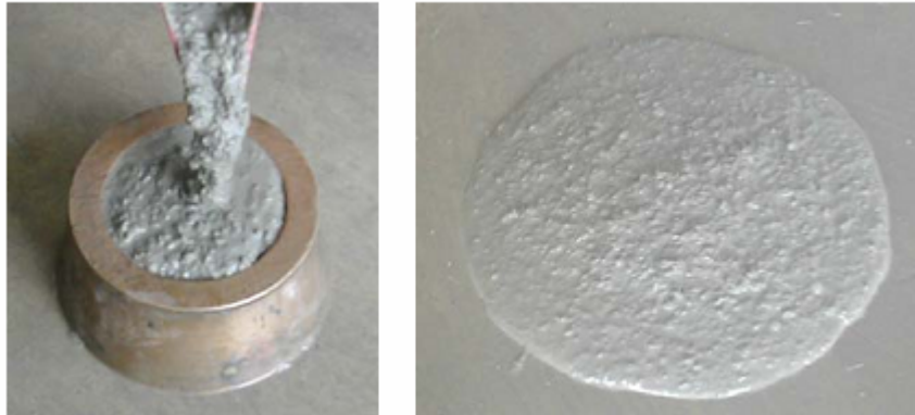
Resim 3.1 Mini çökme hunisinin doldurulması ve karışımın yayılma davranışı
