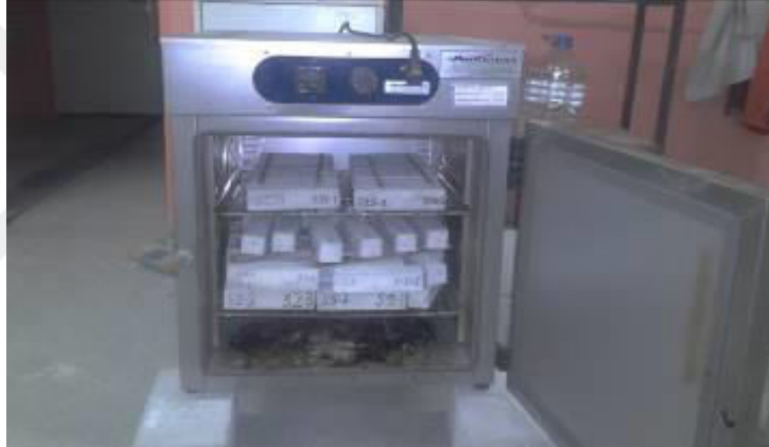
Şekil 3.6. Harç Numunelerini Etüve Konulması
