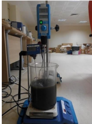
Şekil 2. 25 Kurutma işlemi sonrasında yağı ağartma toprağının eklenmesi
