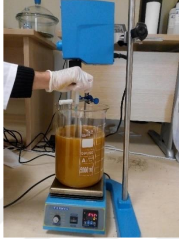
Şekil 2. 22. Yağa fosforik asitin ve NaOH su çözeltisinin eklenmesi
