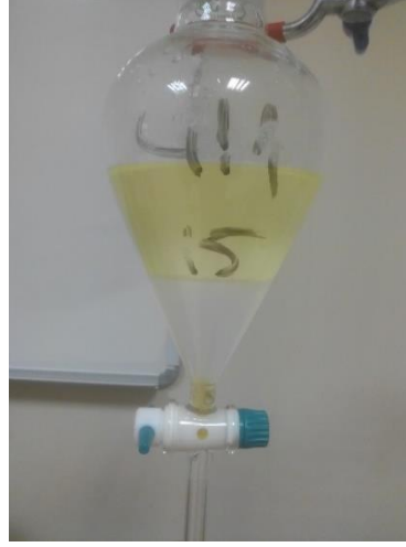
Şekil 2. 29. Biyodizelin duşlama yöntemiyle yıkanması sonucu oluşan faz farkı ve yıkama sonucu ayırma hunisinin dibine çökelen bir miktar gliserol
