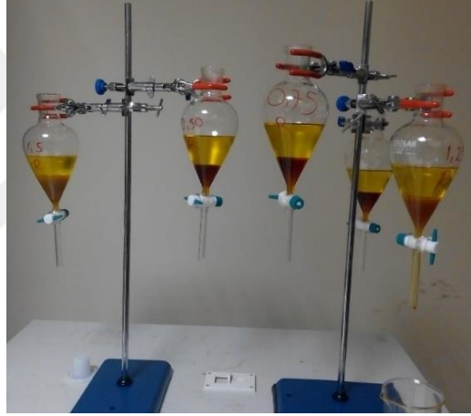
Şekil 2. 28. Transesterifikasyon reaksiyonu sonunda ayırma hunisine alınan biyodizellerin gliserolle oluşturduğu faz farkı
