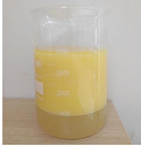
Şekil 2. 24. Yıkama sonrası elde edilen yağ ve yıkama suyu, yağ faz farkı
