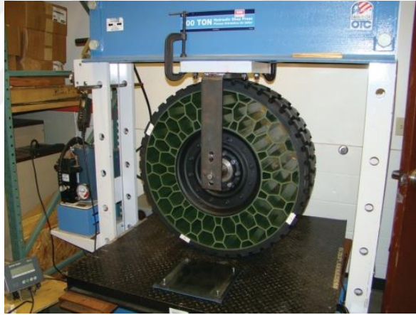
Şekil 3.2. Resilient Technologies Firmasının Petek Desenli HZT’ ler de Dinamik Test Görüntüleri [31]
