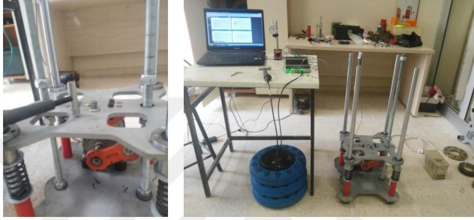
Şekil 5.5. Doğrusal Yataklar ve Tahrik Plakasının Sönüm Katsayısının Bulunması
