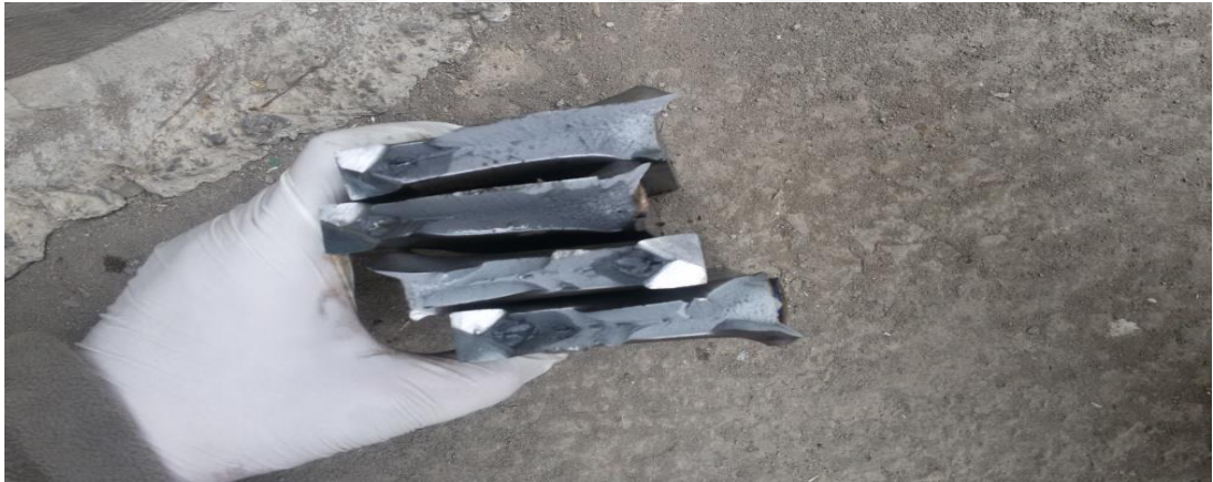
Şekil 6.50. Ağırlık Düşürme Testi İle Kırılmış Numuneler
