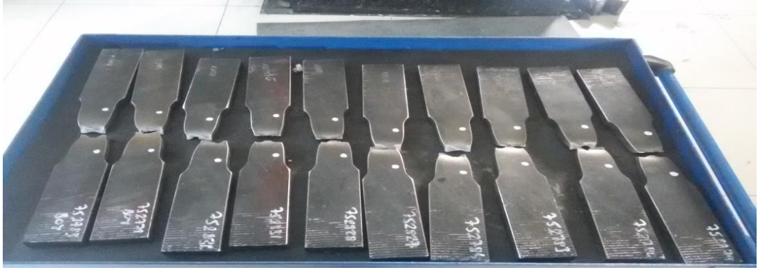
Şekil 6.39. Çekme Testi Yapılmış Numuneler
