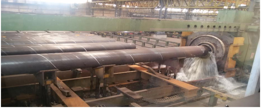
Şekil 6.25. Hidrostatik Test Aşaması
