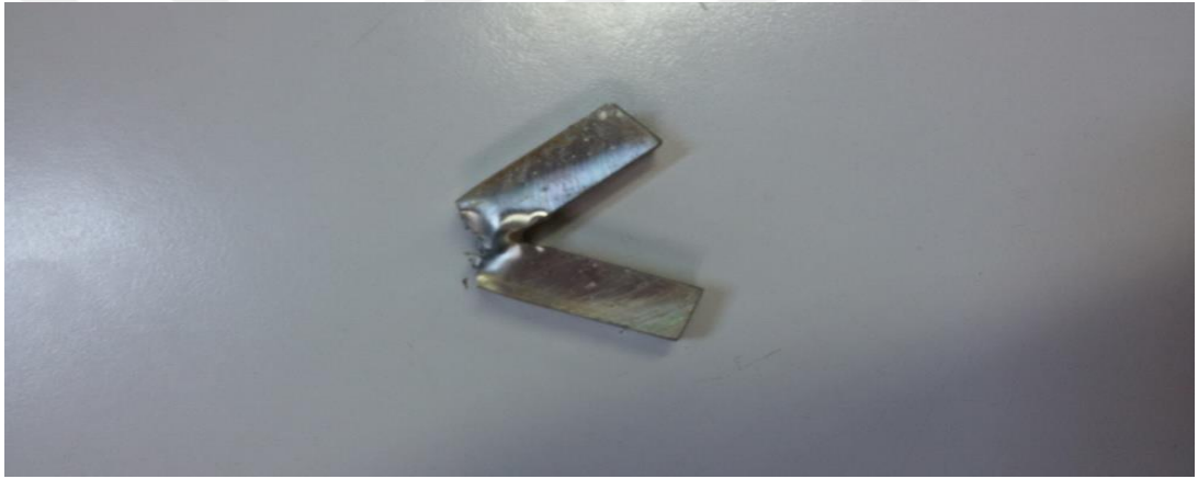
Şekil 6.46. Çentik Darbe Testinden Sonra Kırılmış Numune
