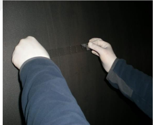
Şekil 6.62. Yüzey Pürüzlülük Testi
