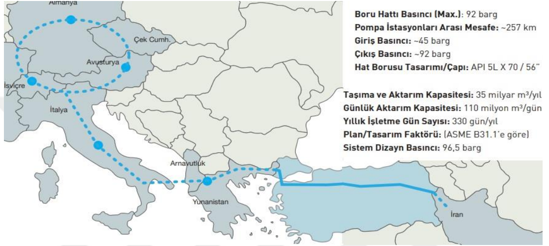
Şekil 4.4. İran – Türkiye- Avrupa Doğal Gaz Boru Hattı ve Teknik Özellikleri [13]
