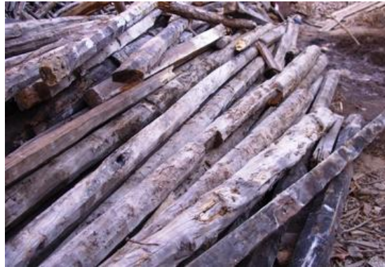
Resim 2.29 Dursunbey evlerinde kullanılmış ahşap malzeme (karaçam).
