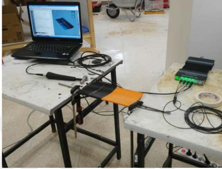
Şekil 5.2. Çekiş Testi Deney Düzeneği
