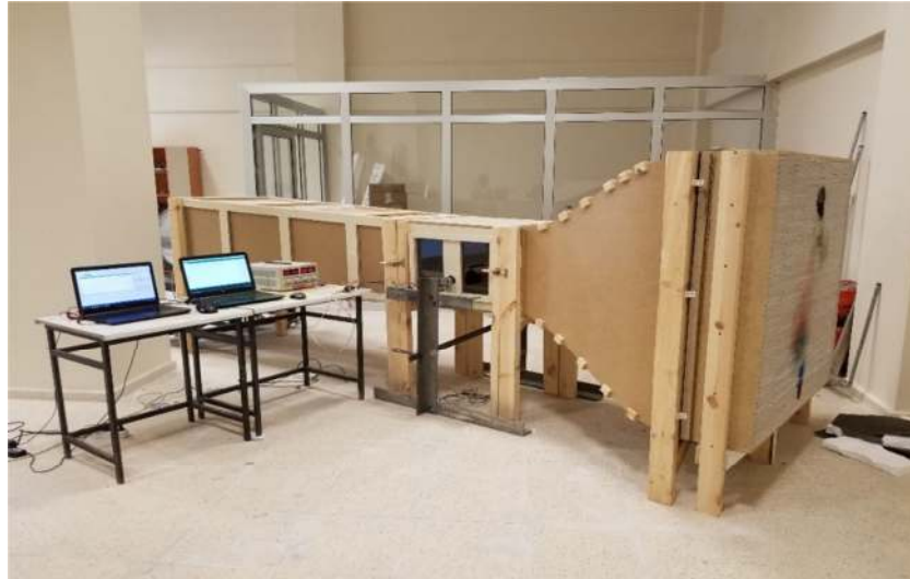
Şekil 4.7. Üretimi Yapılan Rüzgâr Tüneli
