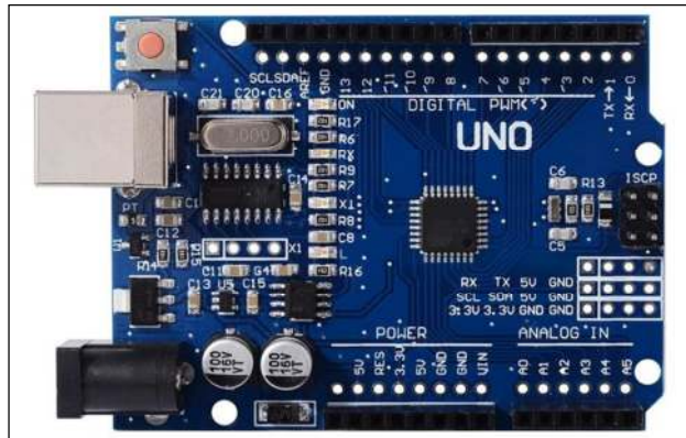
Şekil 4.13. Arduino Uno Kart görünümü
