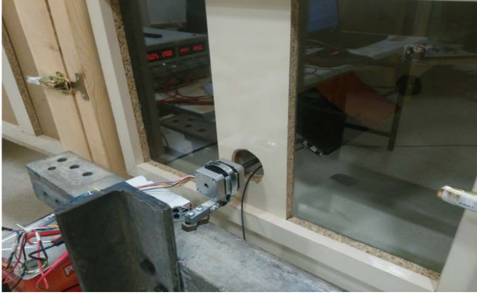
Şekil 5.15. OAR’ın Motor ve Yük Sensörü ile Yataklanması
