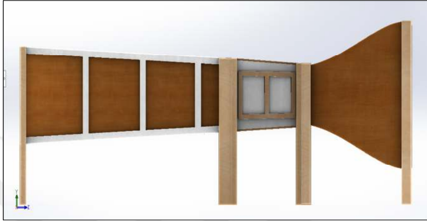
Şekil 4.6. Solidworks Programında Tasarımı Yapılan Rüzgâr Tüneli
