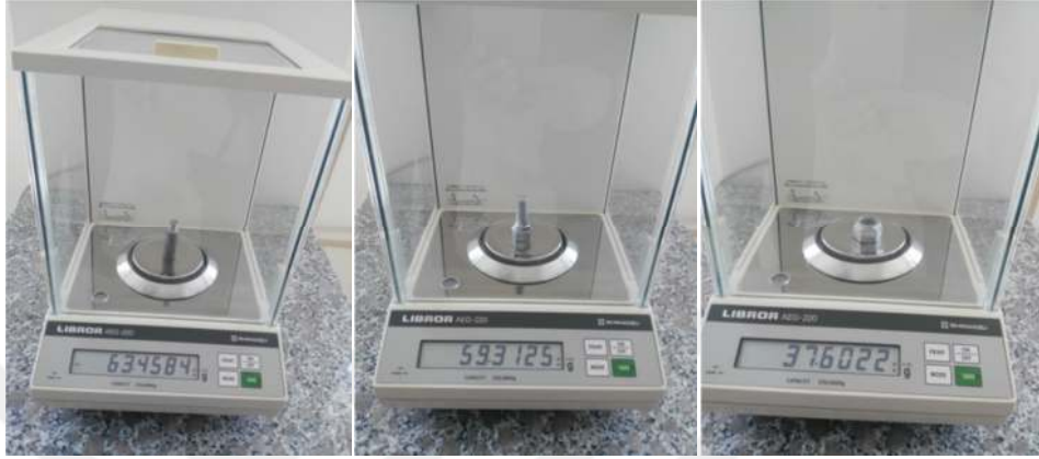
Şekil 4.21. Sehim Ölçümlerinde Kullanılan Yük Deęerlerinin Ölçümü
