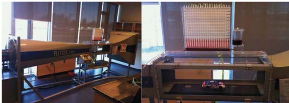
Şekil 3.4. Halil Saadettin ve Arkadaşlarının Deneylerinde Kullandıkları Rüzgâr Tüneli ve Model Araç [15]
