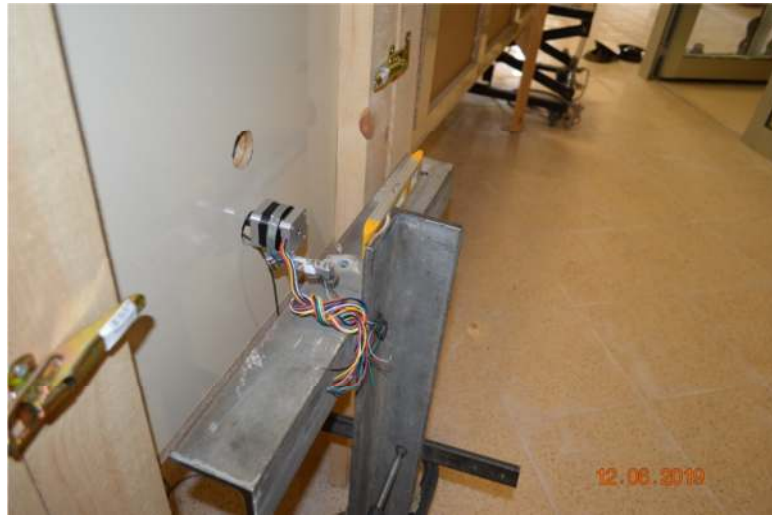
Şekil 4.4. Deney düzeneğinde OAR ile Adım Motor ve Yük Sensörü Bağlantıları
