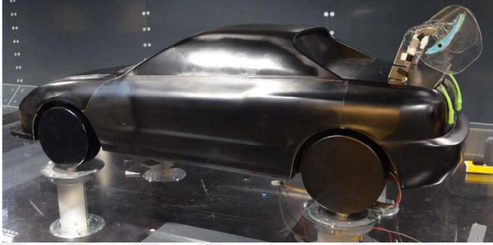
Şekil 3.1. Krzysztof Kurec'in Deneyinde Kullanılan 1:2,5 Ölçekli Otomobil ve Arka Rüzgârlık [7]
