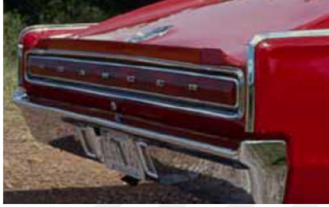
Şekil 2.4. Fabrika Çıkışı Arka Rüzgârlıklı Olan 1967 Model Dodge Charger [4]
