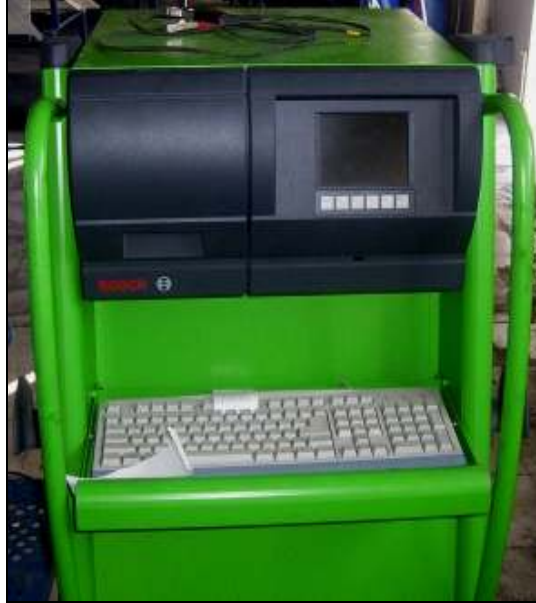
Resim 2.6 Egzoz emisyonu ölçüm cihazı
