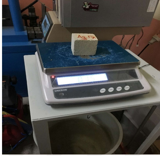
Şekil 3. 13 70x70x70 mm 3 Numunenin Kuru Birim Ağırlığının Elektronik Terazide Tartılması
