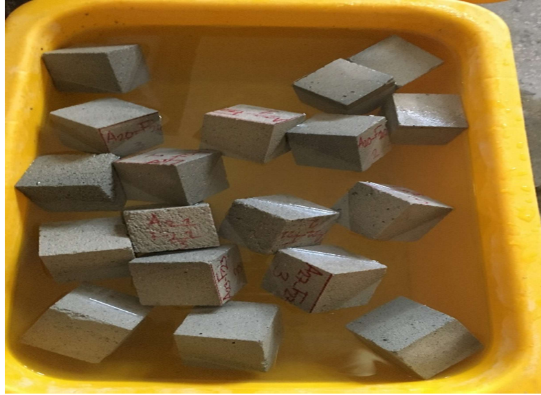
Şekil 3. 14 3 Gün Boyunca Su İçerisinde Muhafaza Edilen Numuneler
