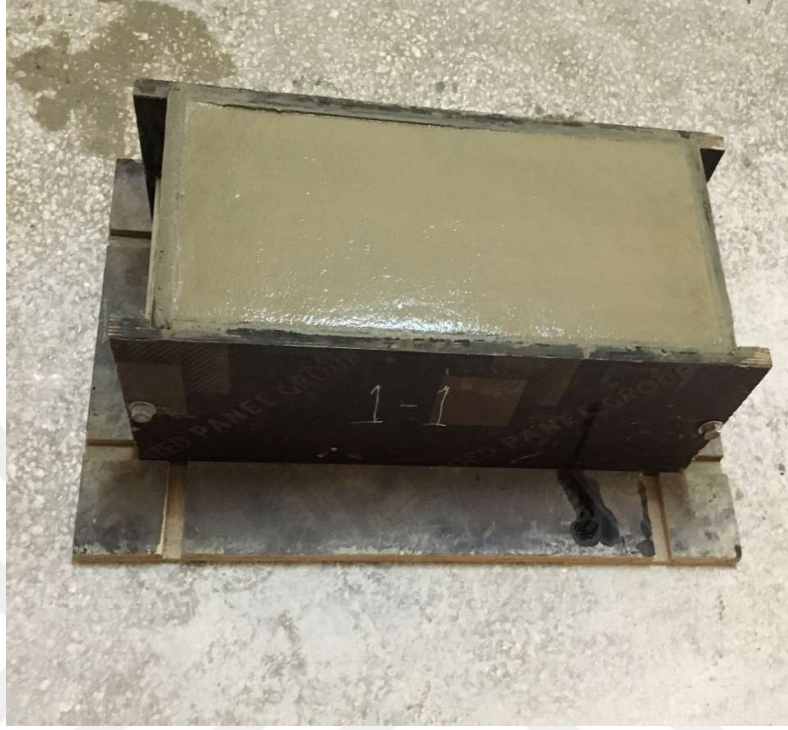
Şekil 3. 10 Fiziksel Deneyler İçin Üretilen 200 \times 200 \times 500 \text{ mm}^3 Numunelerin Priz Alması için 1 gün Kalıpta Bekletilmesi
