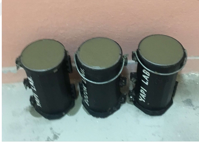
Şekil 3. 9 Üretilen Silindir Numunelerinin Priz Alması için 1 Gün Kalıpta Bekletilmesi
