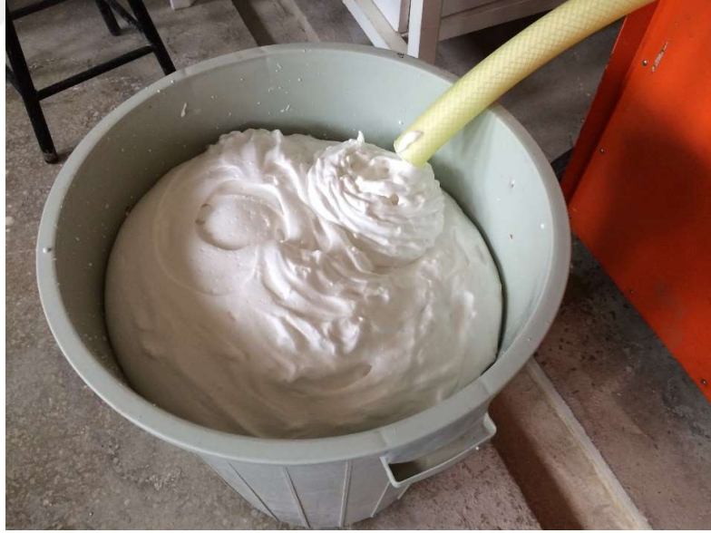
Şekil 3. 7 Köpük Makinasından Basınçlı Hava Yardımıyla Üretilen Köpük
