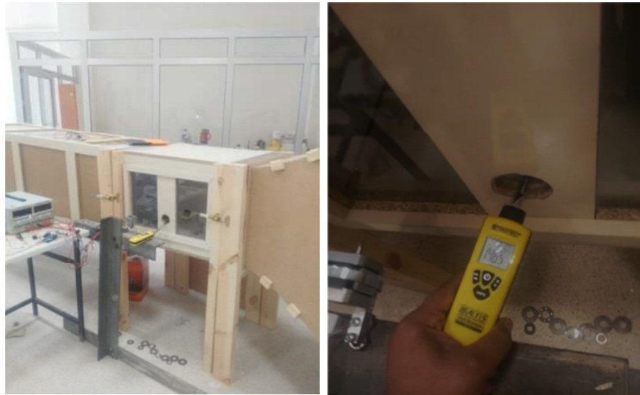
Şekil 4.3. Anemometre İle Akış Hızı Ölçümü
