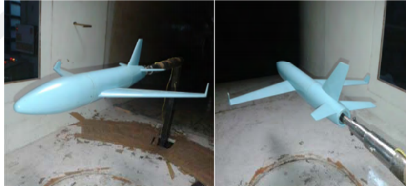
Şekil 2.26. Rüzgâr Tüneline Monte Edilmiş Kanatçıklı Uçak Modeli [58]
