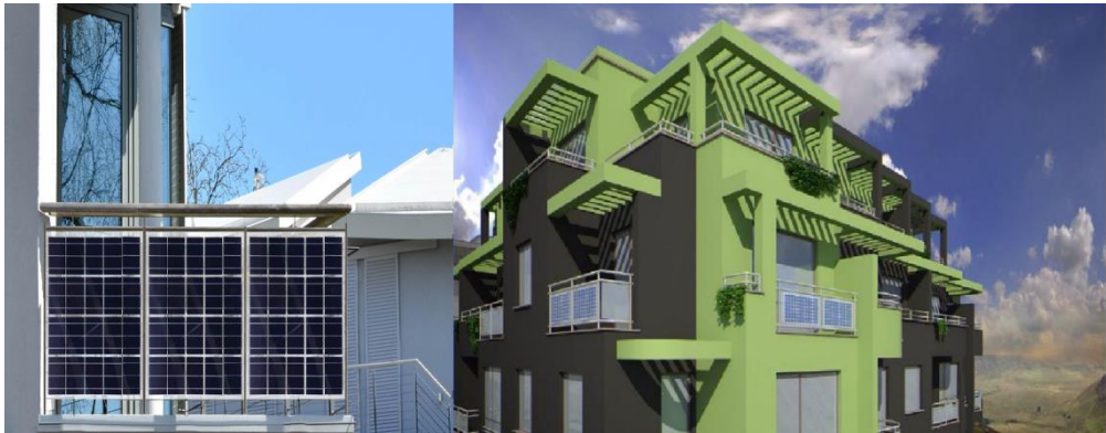
Şekil 2.30 PV'lerin bina korkuluğunda kullanımına ait bir örnek [35]
