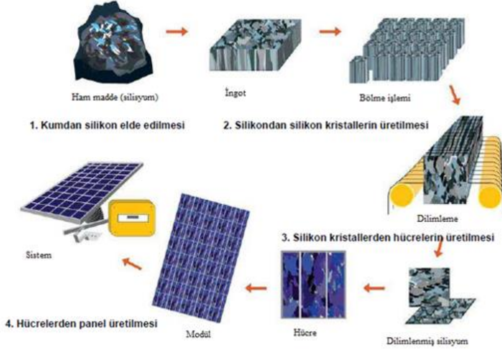
Şekil 2.3 Fotovoltaik modül üretim aşamaları [2]
