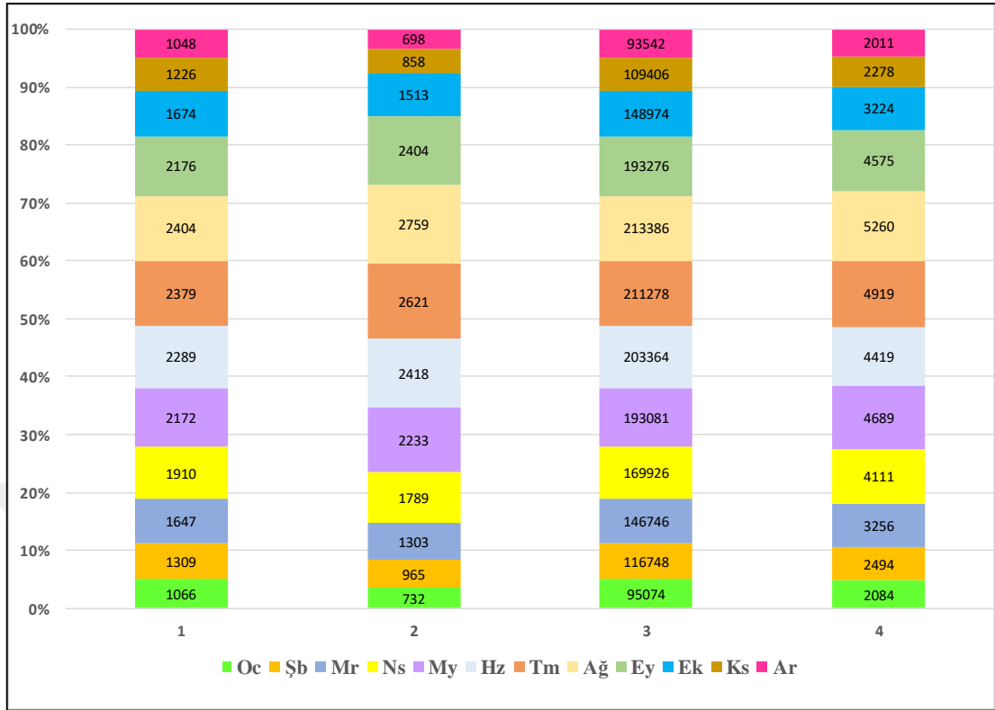
Şekil 6.6 Aylara göre ortalama detaylı sistem kayıpları [ 1: Modül dizisi uyumsuzluğu kaybı (kWh), 2: Ohmik kablolama kaybı (kWh), 3: Serideki maksimum güç noktasındaki sanal enerji kaybı (kWh), 4: Global İnverter kayıpları (kWh)]
