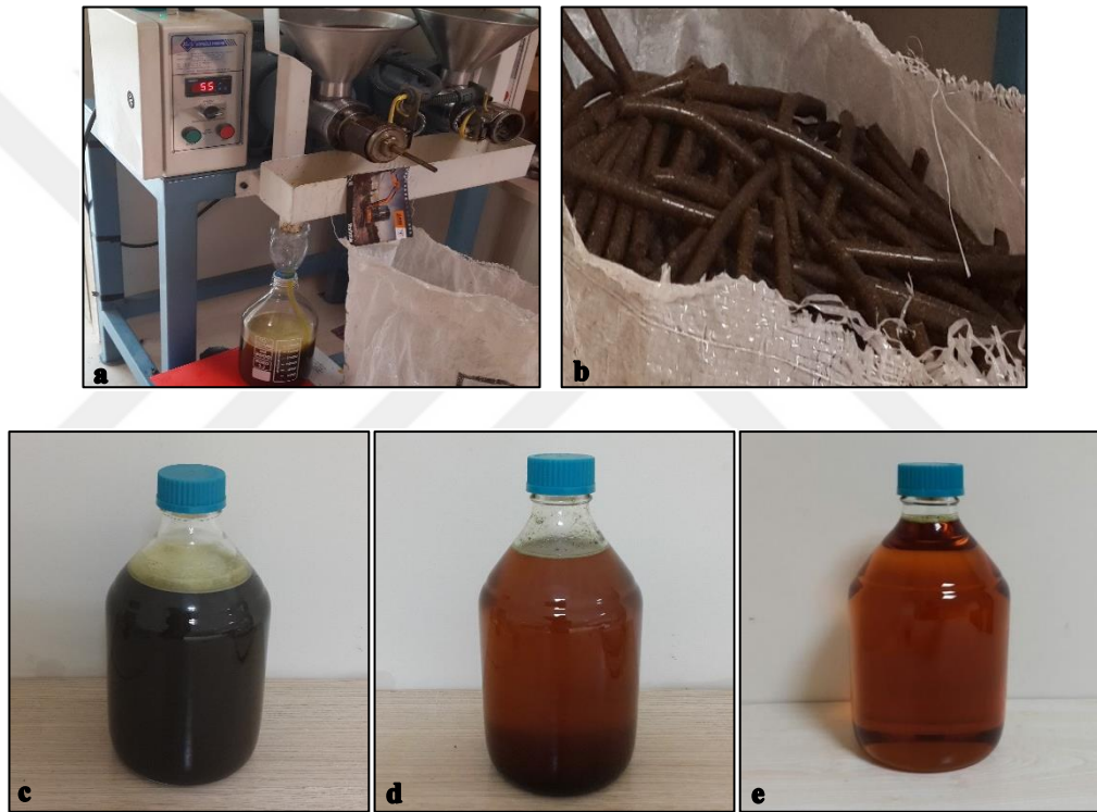
Şekil 4.32. (a) Siyah Hardal Tohumunun Sıkılması, (b) Küspe, (c) Ham Yağ (Sıkım İşleminde Hemen Sonrası), (d) Ham Yağ (Dinlendirilmiş) ve Çöken Küspe Taneleri, (e) Filtre Edilmiş Yağ (SHY)
