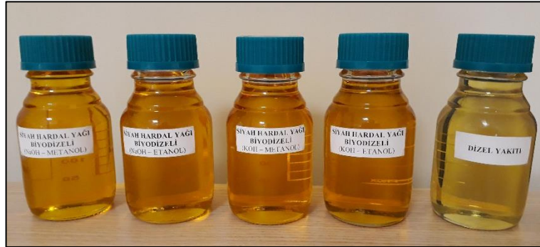
Şekil 4.37. Yakıt Özelliklerinin Belirlenmesi İçin Hazırlanan NaOH MB , NaOH EB , KOH MB , KOH EB ve ED Yakıtlar
