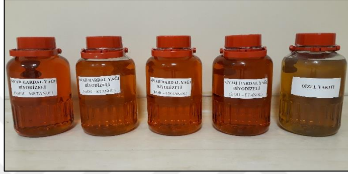
Şekil 4.39. Motor Performans ve Egzoz-Emisyon Değerlerinin Tespit Edilmesi İçin Hazırlanan \text{NaOH}_{\text{MB}} , \text{NaOH}_{\text{EB}} , \text{KOH}_{\text{MB}} , \text{KOH}_{\text{EB}} ve ED Yakıtlar
