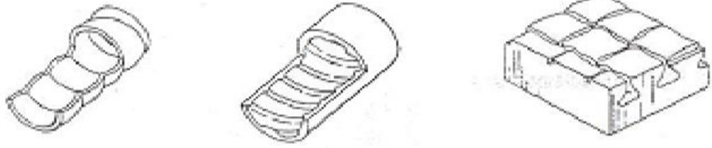
Şekil 1.1. Akışkan yüzeyi pürüzlü hale getirilmiş boru ve levha [2]
