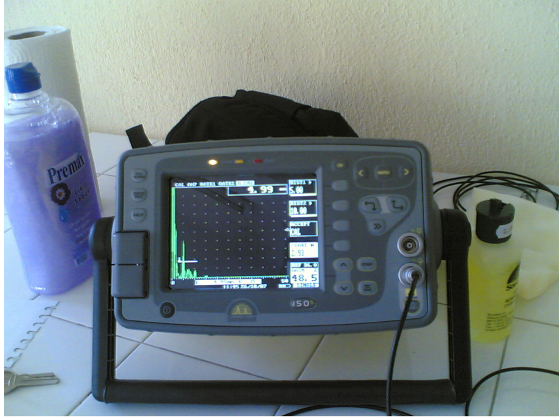
Şekil 12. Ultrases hız ölçümlerinde kullanılan Sitescan 150 cihazı.
