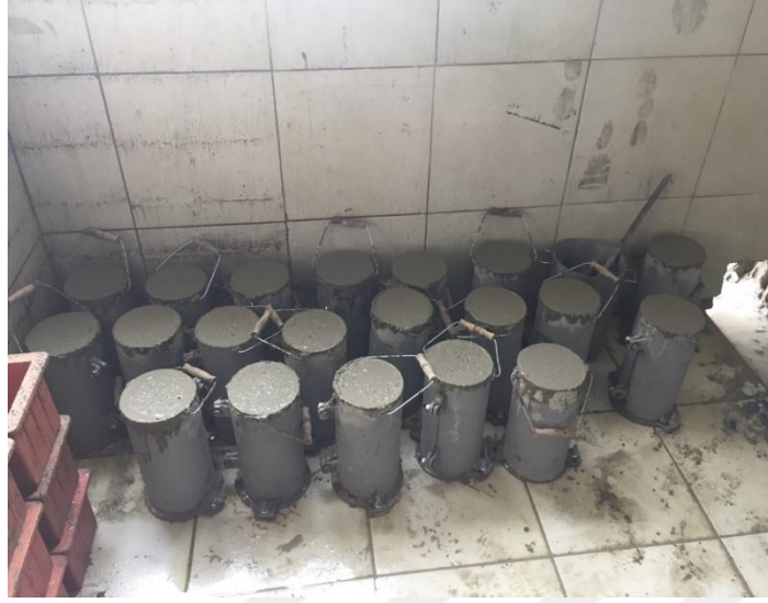
Şekil 4.7. C25 Hazır Beton Doldurulmuş Silindirler
