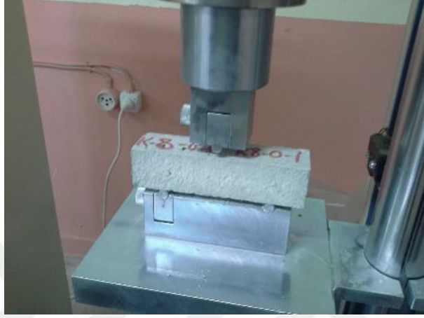
Şekil 3.13. Eğilme Dayanımı Deneyi Düzeneği
