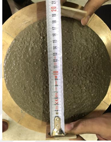
Şekil 3.12. Yayılma Tablası Deney Düzenegi
