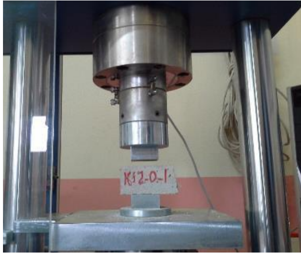
Şekil 3.14. Prizmatik Harç Basınç Dayanımı Deney Düzeneği
