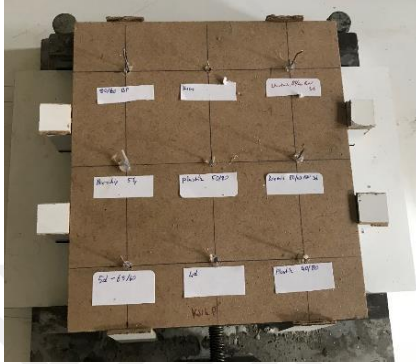
Şekil 3.5. Liflerin Silikon ile Sabitlenmesi
