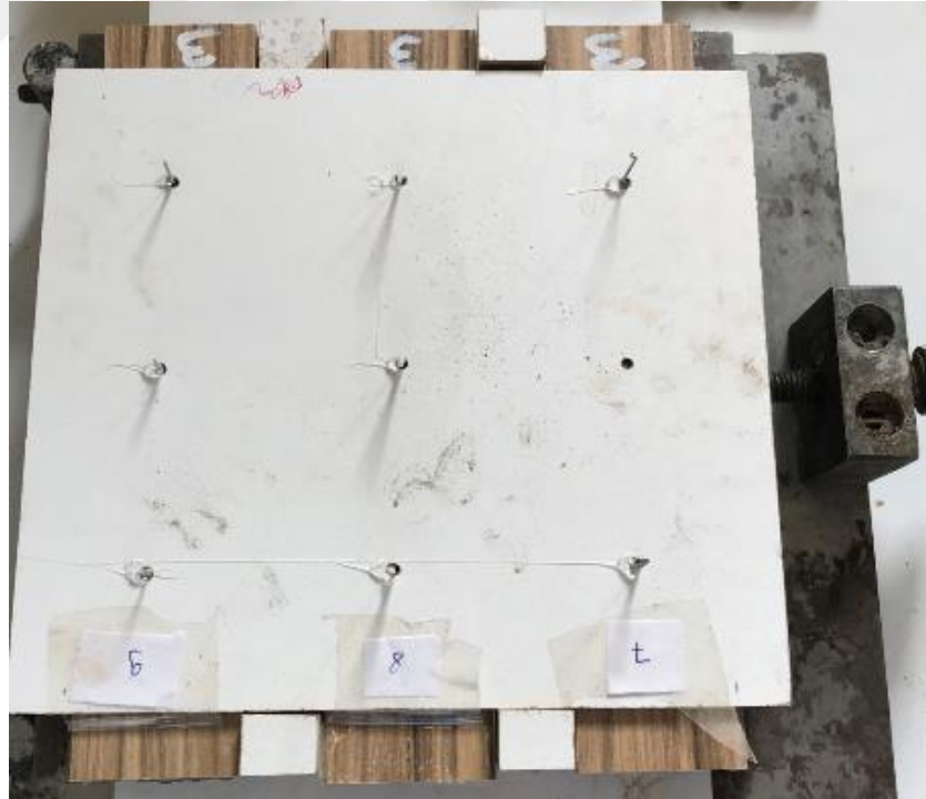
Şekil 3.5. Liflerin Silikon ile Sabitlenmesi
