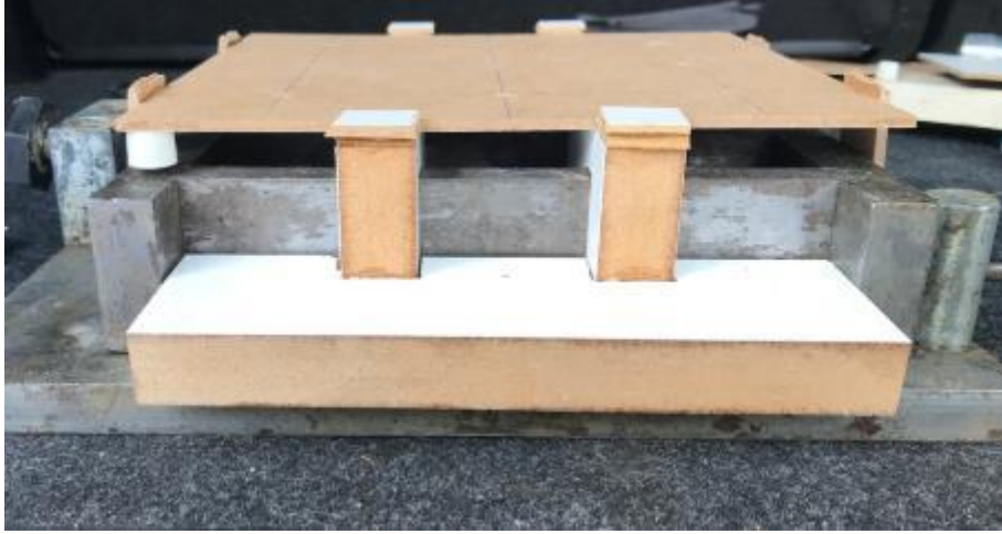
Şekil 3.4. Ahşap Kalıp Başlığı Yandan Görünüş
