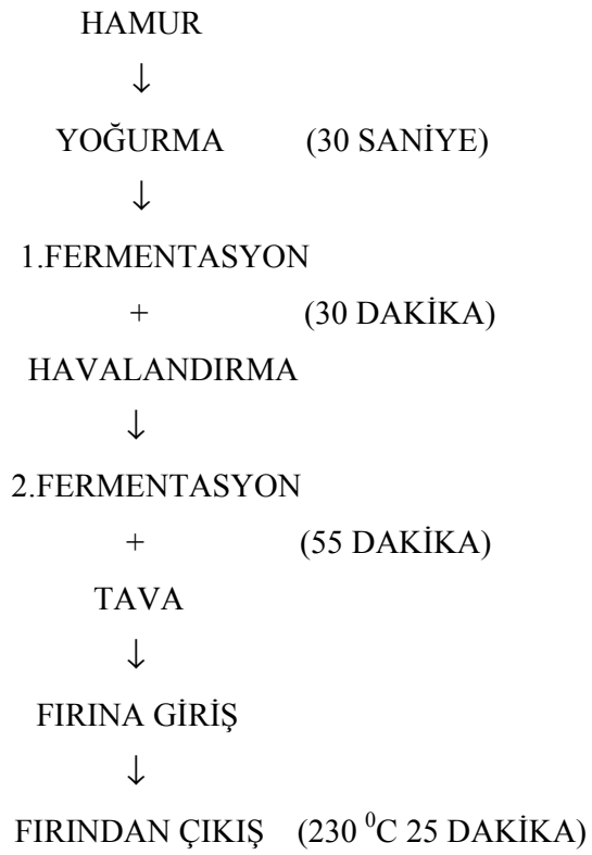
Şekil 3. 1. İndirekt hamur yöntemiyle hazırlanan ekmek akış şeması
