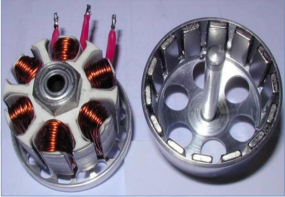
Ŗekil 3. 4 Fırasız Tip DC Motor (DıŖ Rotor ve Stator)
