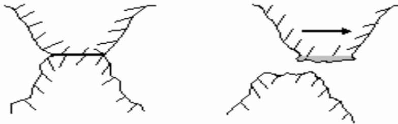
Şekil 2.14 Adhezif aşınmanın meydana gelişinin şematik olarak gösterimi (Güneş 2006).
