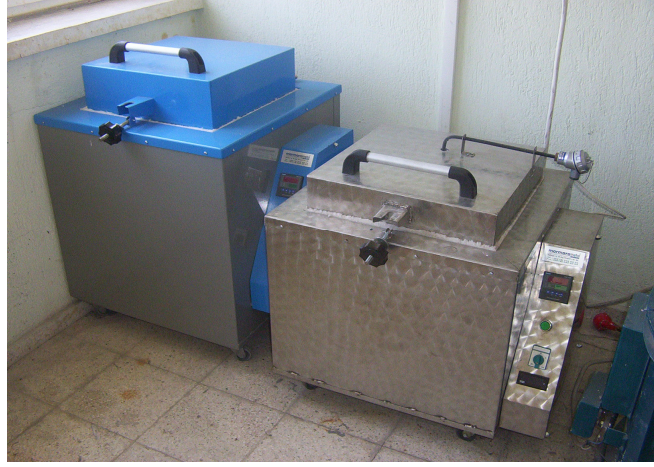
Resim 3.2 Borlama ve Östempereleme işlemlerinde kullanılan fırınlar.
