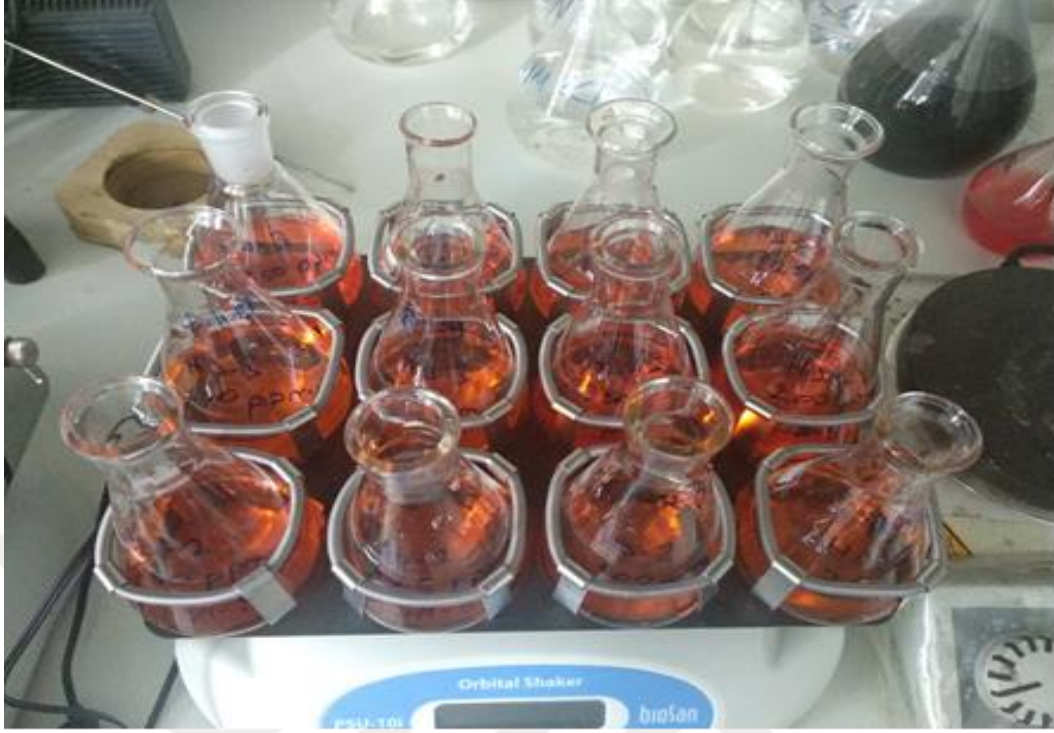
Şekil 3.9. Adsorpsiyon çalışmalarında kullanılan çalkalayıcı
