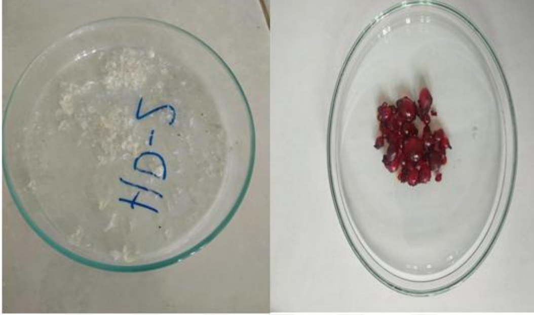
Şekil 3.8. Sentezlenen ve boya adsorplamış hidrojellerin görüntüsü
