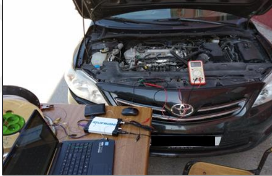
Şekil 31 Enjektör Ölçümlerinin Yapılması
