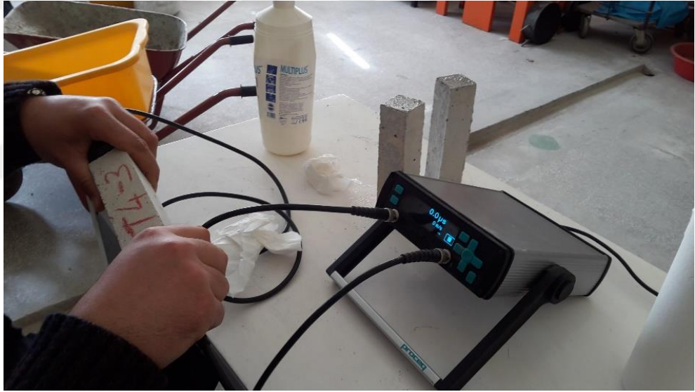
Şekil 3.11 Ultra Ses Geçiş Hızının Belirlenmesi
