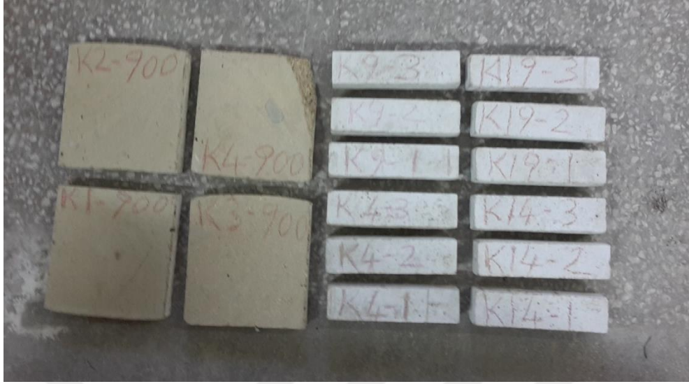
Şekil 4.2 Numunelerin 900 °C Sıcaklığa Maruz Bırakıldıktan Sonraki Durumu
