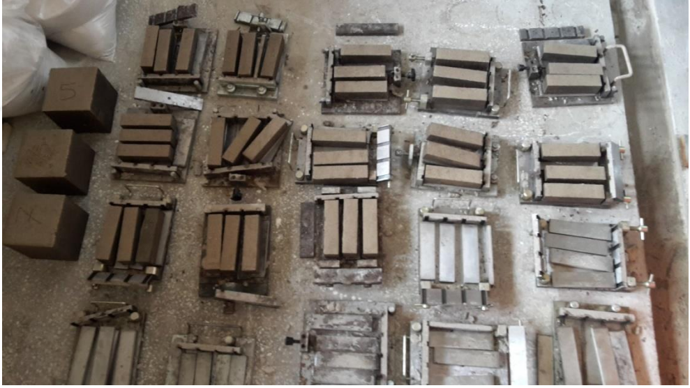
Şekil 3.4 Numunelerin 24 Saat Sonunda Kalıptan Çıkarılması
