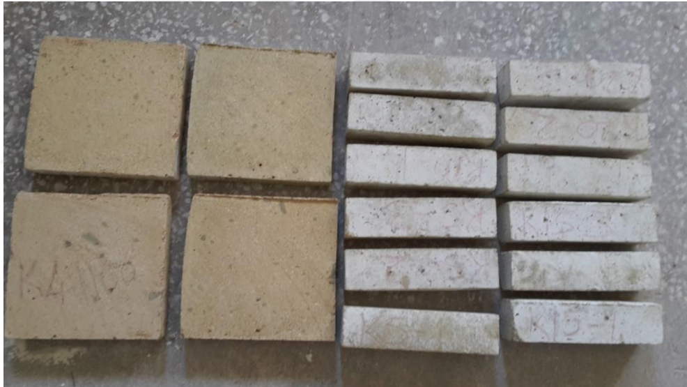
Şekil 4.3 Numunelerin 1100 °C Sıcaklığa Maruz Bırakıldıktan Sonraki Durumu
