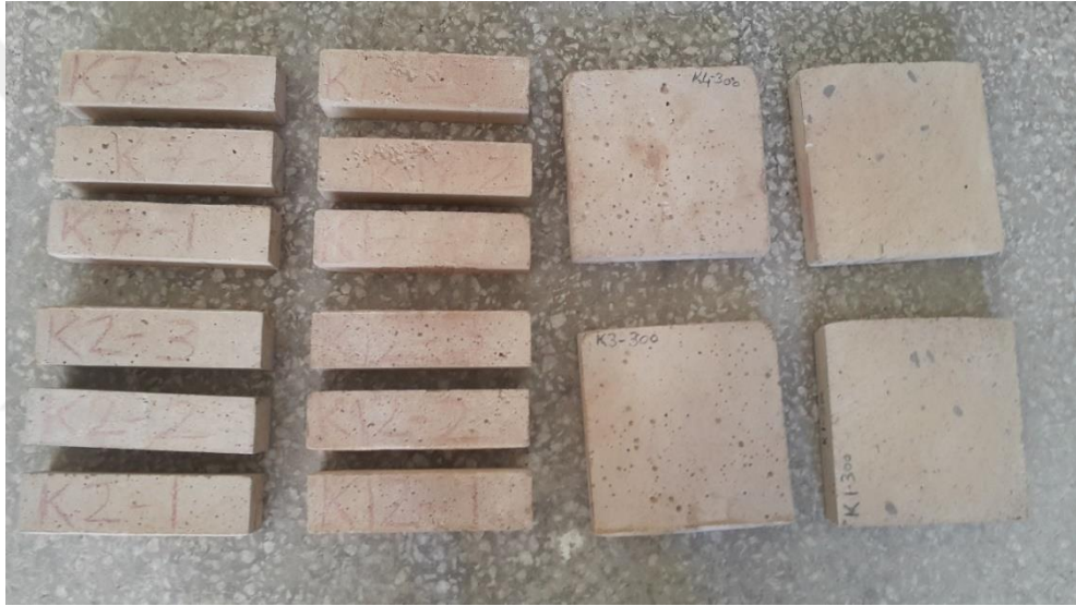
Şekil 4.1 Numunelerin 300 °C Sıcaklığa Maruz Bırakıldıktan Sonraki Durumu
