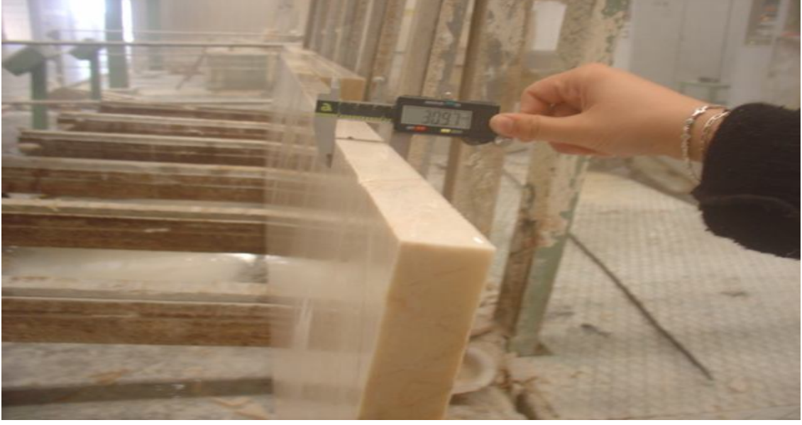
Resim 4.4 Dairesel Testereli Blok Kesim Makinesinde kesilen plaka
