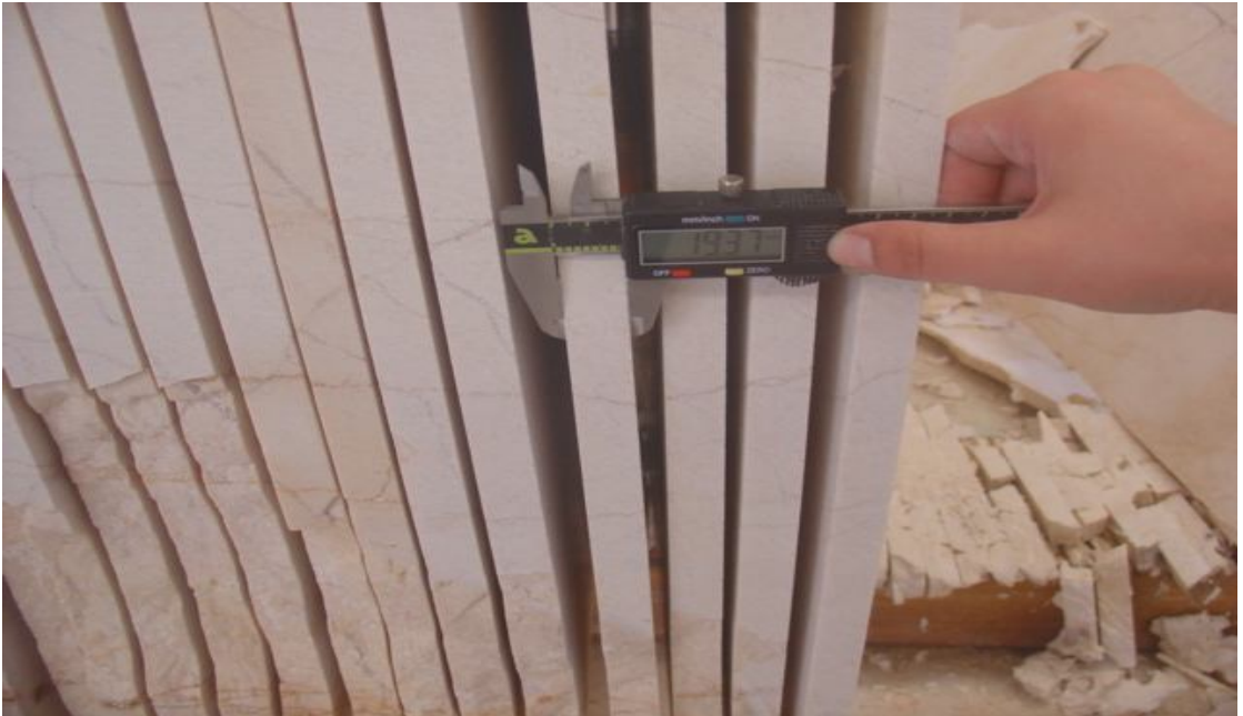
Resim 4.2 Katraklardan Dijital Kumpasla Alınan Levha Ölçümleri
