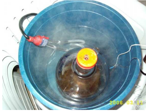
Resim 2.1 Karışımın 8 saat boyunca 60°C de sabit sıcaklıkta tutulması
