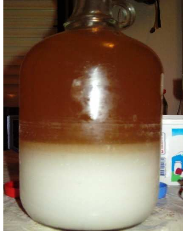
Resim 2.2 Karışımın dinlendirilmesinden sonraki alt ve üst faz oluşumu
