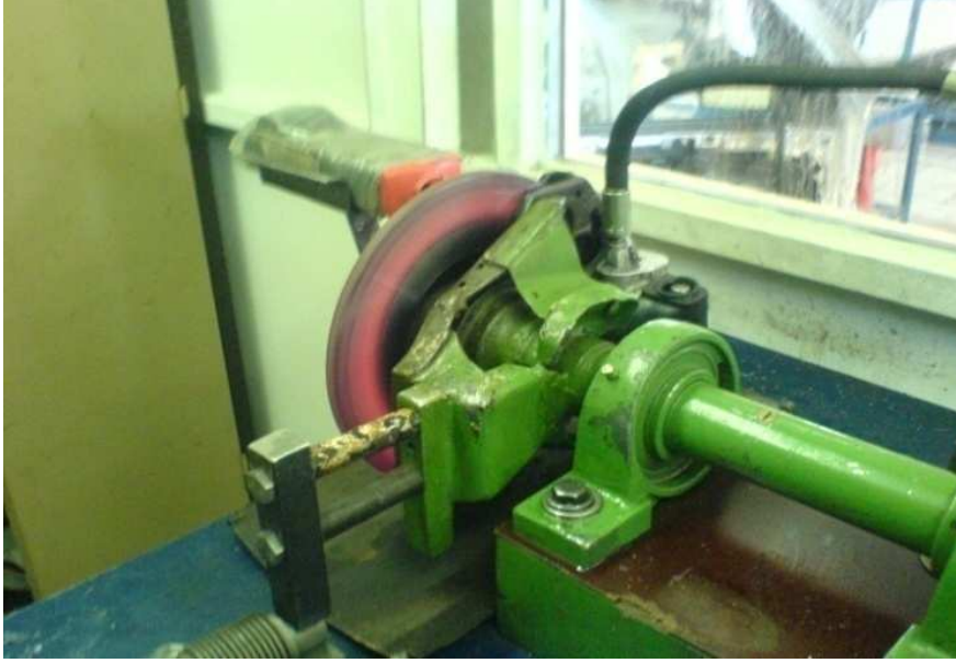
Resim 3.1 Üretilen Fren Balatası Numunelerinin Deney Esnasındaki Sürtünmeden Dolayı Oluşan Isının Fren Diskinde Meydana Getirdiği Durum
