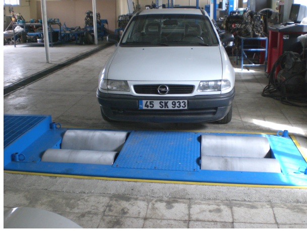
Resim 2.6 Taşıtın Şasi Dinamometresine Girişi
