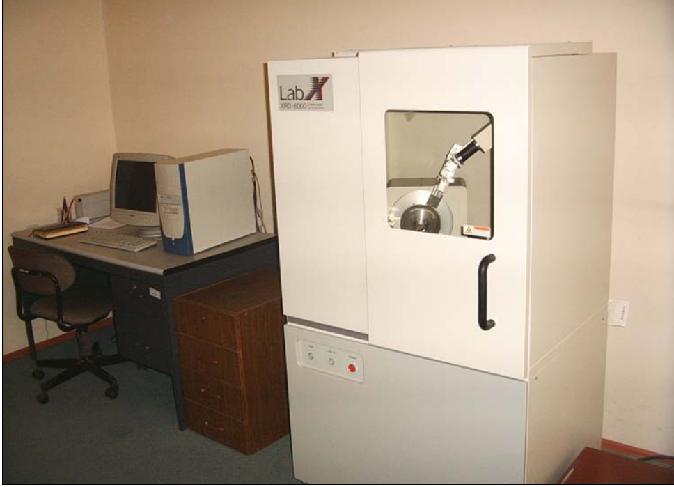
Resim 3.3. Shimadzu XRD-6000 model X-ışını difraktometre cihazı (AKU, TUAM).
