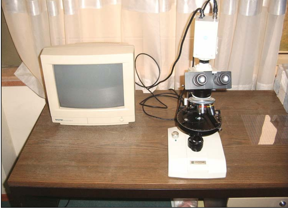
Resim 3.1. A.K.Ü. Teknoloji Uygulama Araştırma Merkezi'ndeki Euromex marka polarizan mikroskop.
