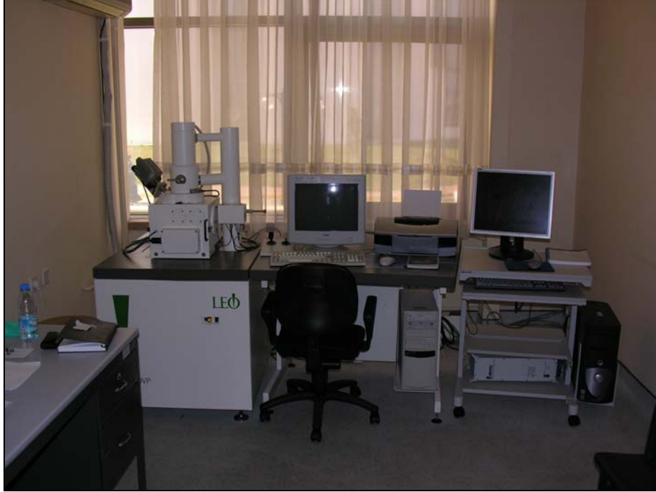
Resim 3.2. LEO VP-1431 model elektron mikroskobu (AKÜ, TUAM)
