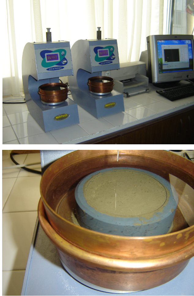
Resim 3.3 Matest marka otomatik vicat cihazı ve test öncesi çimento pastası.
