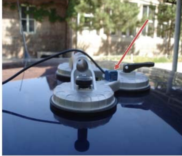
Resim 5.4 İvme Ölçer Sensorunun Araca Montajı.
