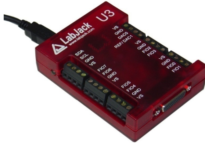
Resim 5.5 U3 Veri Aktarıcısının Görünüşü (İnt.Kyn. 7).
