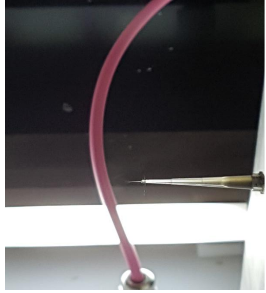
Şekil 3.5. Elektro lif çekim cihazı ve GM polimerinden lif çekimi görüntüsü
