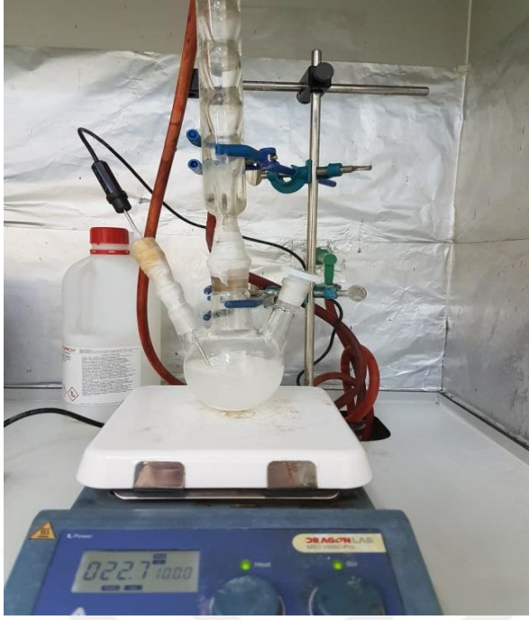
Şekil 3.1. Gümüş naftenat ve abitatların sentezlenmesi
