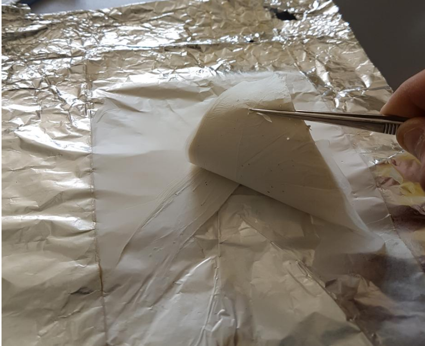
Şekil 3.6. Elektro lif çekim yöntemi ile elde edilen liflerin toplanması
