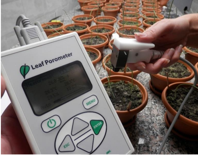
Şekil 3.3. Bitki yapraklarının stoma iletkenliğinin ölçümü (Özgün)
